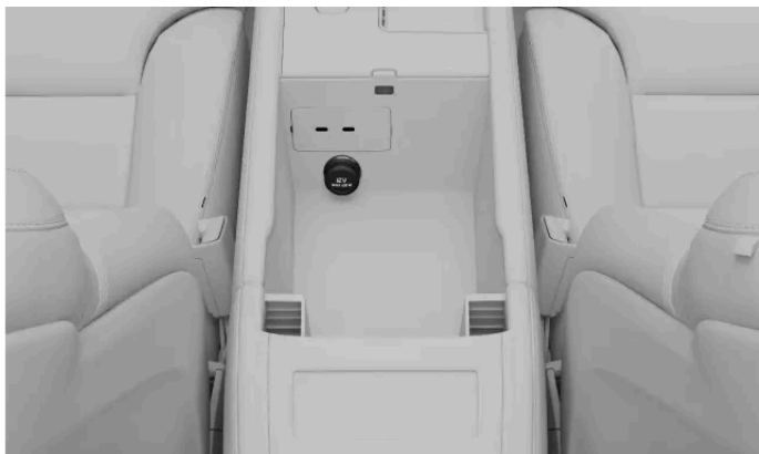
12V elektrická zásuvka v tunelové konzole
