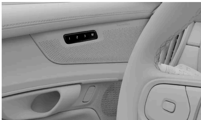
Umístění tlačítek předvolených nastavení sedadel
