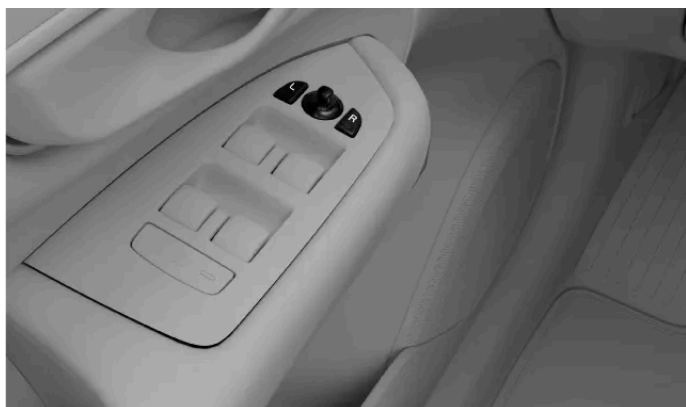
Ovládací prvky pro nastavení vnějších zpětných zrcátek
