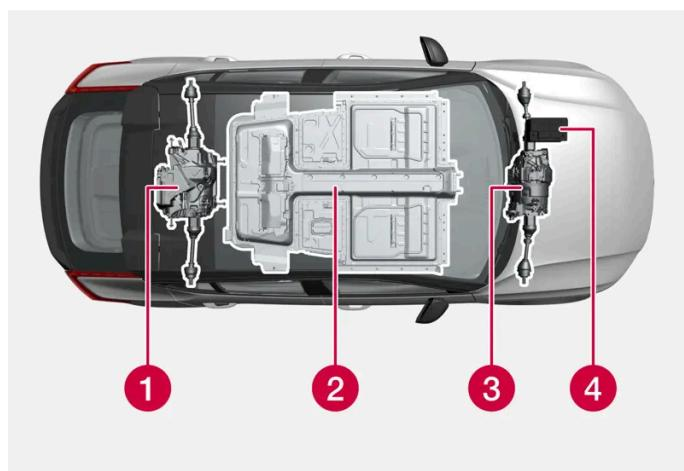
**1** Elektromotor - Das Fahrzeug besitzt einen Elektromotor, der den Antrieb besorgt und Bremsenergie als Elektroenergie rückgewinnt.
