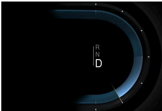
Anzeige einer stattfindenden Bremsenergierückgewinnung auf dem Fahrerdisplay.
