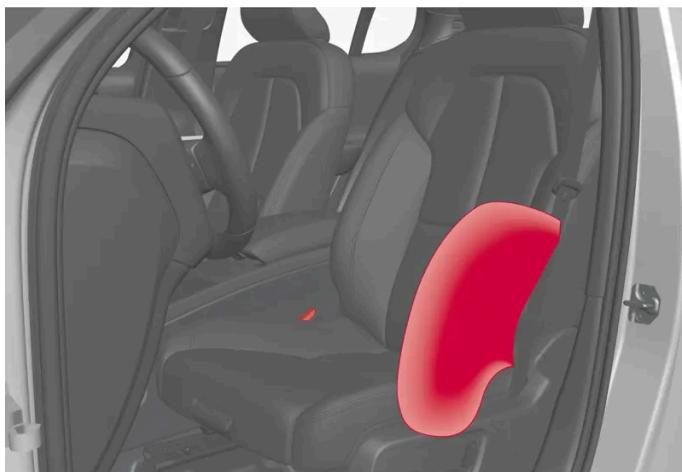
Die äußeren Seitenairbags sind im Außenrahmen der Rückenlehnen montiert und helfen, Fahrer und Beifahrer in den Vordersitzen zu schützen.
