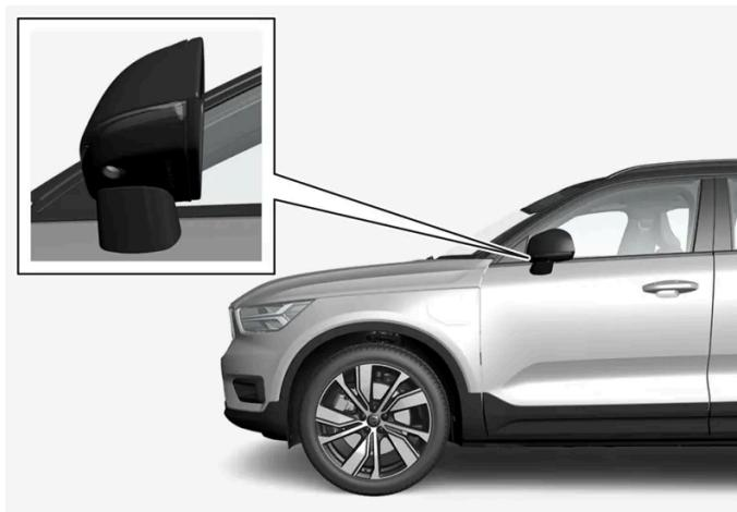
Die Seitenkameras befinden sich in den Seitenspiegeln.
