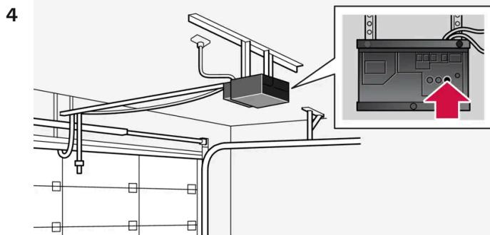
Finden Sie die Anlerntaste [2] am Empfänger, z. B. Garagentor. Die Platzierung ist normalerweise in der Nähe der Antennenfassung am Empfänger.
