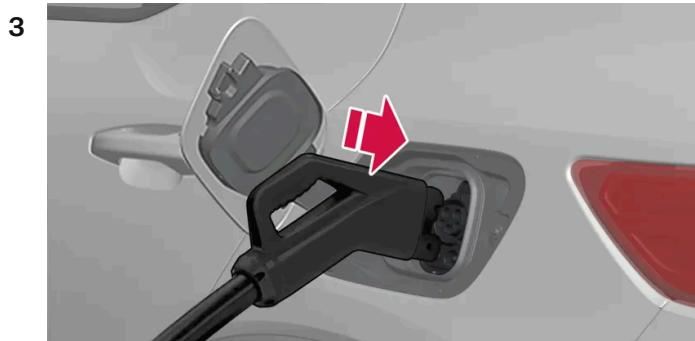
Das Ladekabel mit beiden Händen greifen und vollständig in die Ladebuchse des Fahrzeugs einführen. Den Ladestutzen einige Sekunden oben halten. Nach einigen Sekunden wird das Ladekabel automatisch in der Ladebuchse verriegelt. Kontrollieren, dass das Ladekabel ordnungsgemäß verriegelt ist und der Ladevorgang starten kann.
