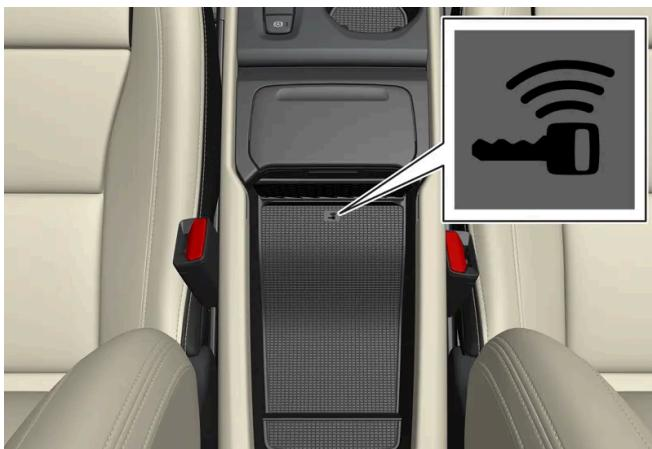
Legen Sie den Schlüssel auf das Schlüsselsymbol des Schlüssellesegeräts im Ablagefach der Tunnelkonsole.
