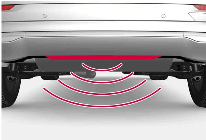
Der Sensor befindet sich in der Mitte des Stoßfängers.
