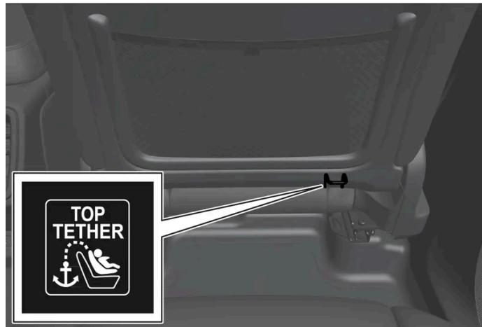
Die Platzierung des Befestigungspunkts für den Beifahrersitz wird durch einen Symbol an der Rückseite des Sitzes kenntlich gemacht.
