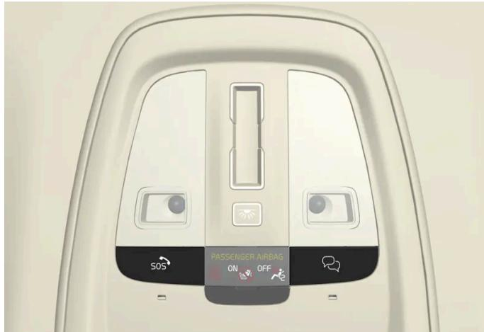
Die Funktionen sind über die
