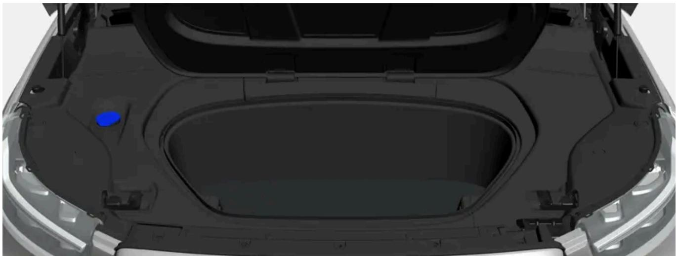
Unter der Frontklappe befindet sich weiterer Stauraum. Im Gepäckraum befindet sich auch die Abschleppöse und der Reifendichtungssatz.
