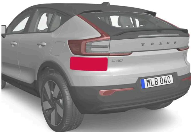
Platzierung der hinteren Radareinheiten
