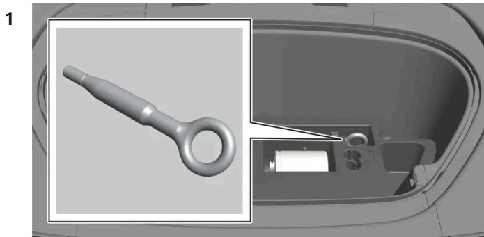
Die Abschleppöse aus dem Schaumblock unter der Frontklappe herausnehmen.
