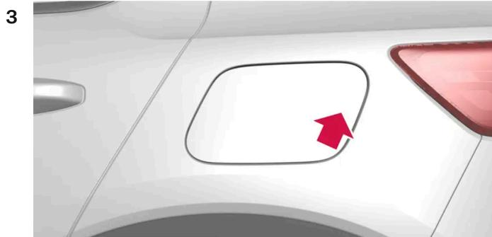
Hinteren Teil des Deckels nach innen drücken, um den Deckel <sup>[2]</sup> zu öffnen.
