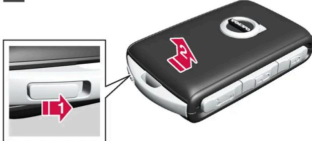
Bewegen Sie den Schieber zur Seite und die oberen Abdeckung aus der verriegelten Position.
