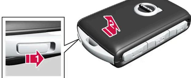
Bewegen Sie den Schieber zur Seite und die oberen Abdeckung aus der verriegelten Position.
