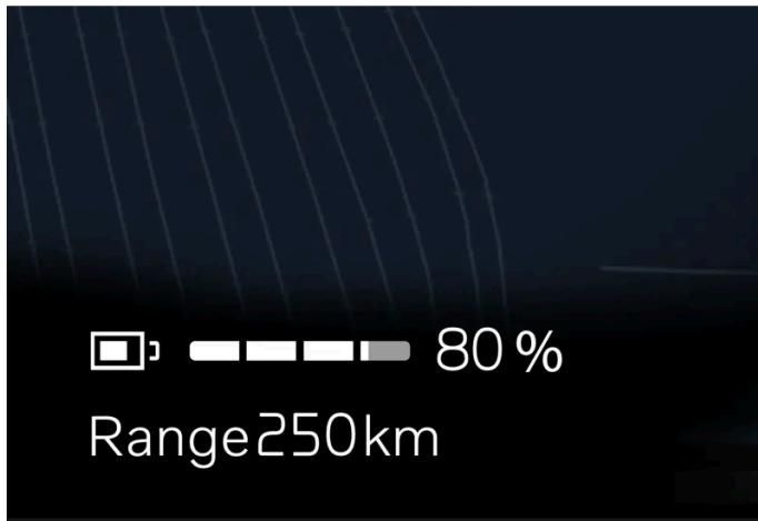
An der Batterieanzeige im unteren Bereich des Fahrerdisplays lässt sich der Ladezustand der Hochvoltbatterie ablesen. Wenn die verbleibende Reichweite unter 50 km (30 Meilen) liegt, wird dies neben der Batterieanzeige eingeblendet. Die Reichweite kann von äußeren Faktoren abhängen, wie z. B. Fahrweise und Temperatur.
