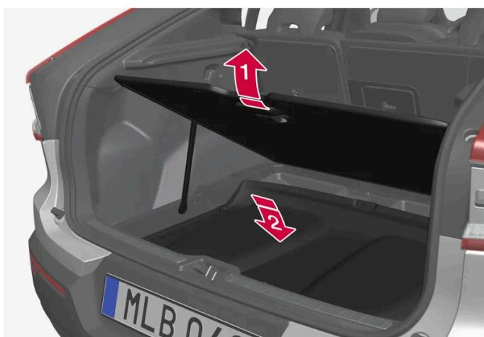
Die entfernte Hutablage kann unter dem Ladeboden verstaut werden.
