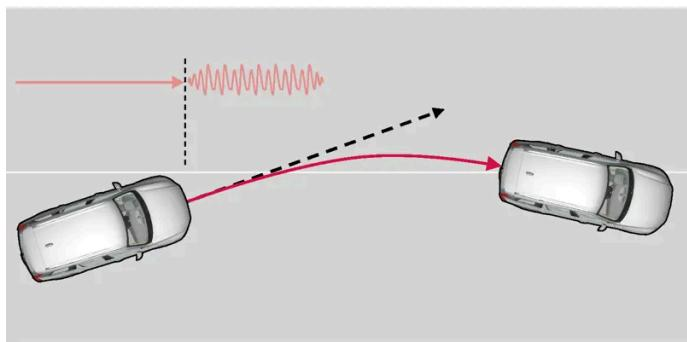
Der Spurassistent warnt den Fahrer mit Lenkradvibrationen.
