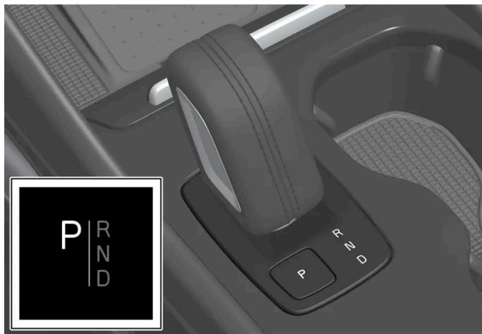
Auf dem Fahrerdisplay wird angezeigt, welche Schaltstellung derzeit verwendet wird.
