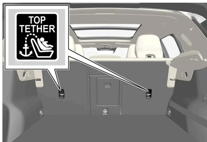
Sie erkennen die Befestigungspunkte für den Rücksitz an den Symbolen an der Rückseite der Rückenlehne.
