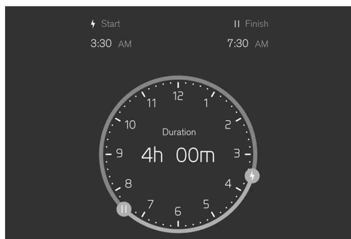
Wählen Sie auf dem Center Display **Aufladen** → **Timer einstellen** aus und aktivieren Sie anschließend über **Ladevorgang planen** das planmäßige Laden. Ziehen Sie die Symbole und an die gewünschte Stelle, um die Start- und Endzeit der Aufladung einzustellen.
