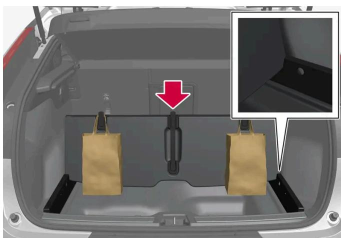
**1** Handgriff in der Mitte des Ladebodens anheben und Bodenplatte hochklappen.
