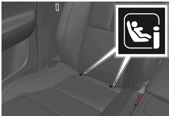
Sie erkennen die Befestigungspunkte für den Beifahrersitz an den Symbolen an der Rückenlehne.
