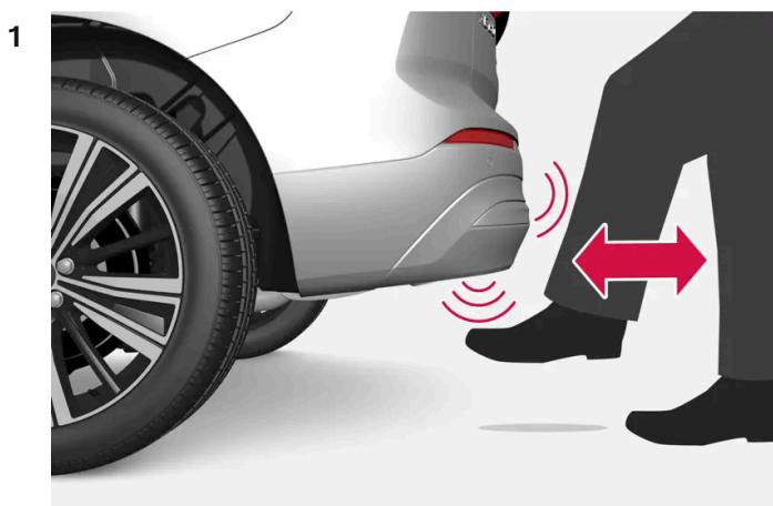
Führen Sie im Sensorbereich unter dem Heckstoßfänger **eine** nach vorn gerichtete Fußbewegung aus. Danach einen Schritt zurücktreten. Berühren Sie den Stoßfänger nicht.
