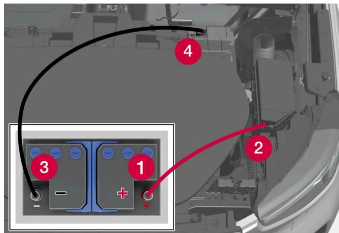
Um an die Ladepunkte unter der Frontklappe zu kommen, müssen mehrere Verkleidungen im Bereich des Staufachs abgenommen werden.
