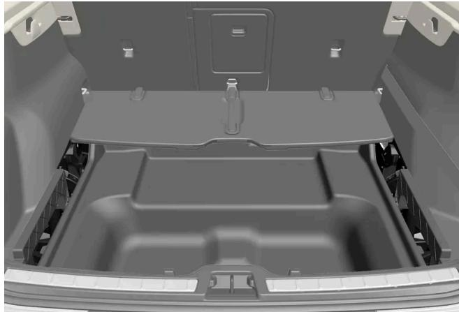
Den Ladeboden an den Faltstellen nach vorne falten, um die Hutablage mit der Oberseite nach unten gewendet und dem hinteren Teil nach vorn verstauen zu können.
