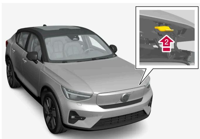
2 Führen Sie den Griff unter der Frontklappe zum Entriegeln nach oben und heben Sie die Klappe dann an.
