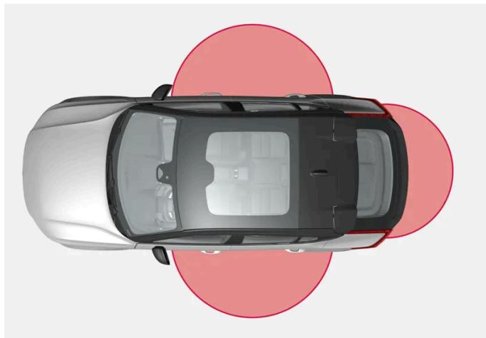
Für die schlüssellose Bedienung muss sich ein Schlüssel in einer Entfernung von ca. 1 bis 1,5 Meter (3 bis 5 Fuß) von den Fahrzeugtüren oder der Heckklappe befinden.
