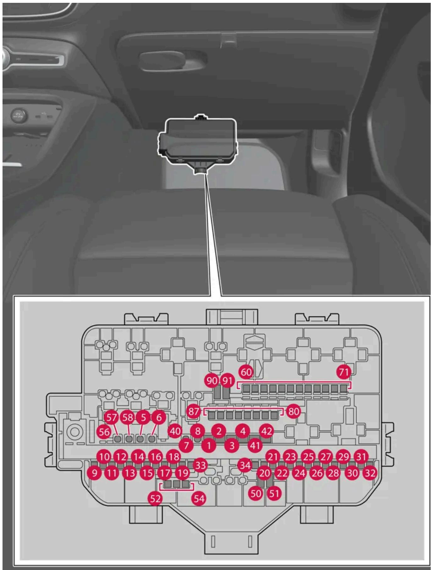
Der Sicherungskasten befindet hinter der Bodenmatte/Verkleidung.
