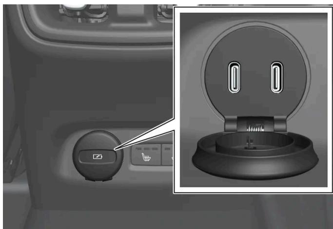
USB-Anschlüsse (Typ C) in der Tunnelkonsole, Fond.
