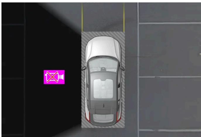
Anzeigbeispiele, wenn die linke Kamera des Fahrzeugs außer Funktion ist.
