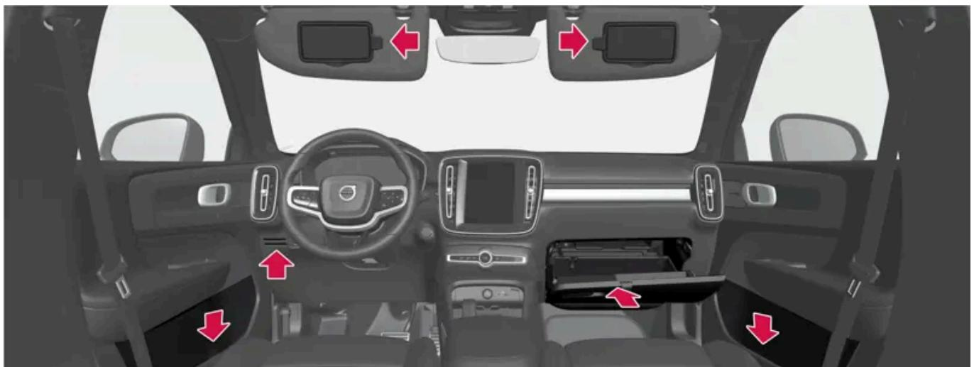
Ablagefach in der Türverkleidung, Kartenhalter\* neben dem Lenkrad, Sonnenblenden sowie Handschuhfach mit Ausklappfächern.
