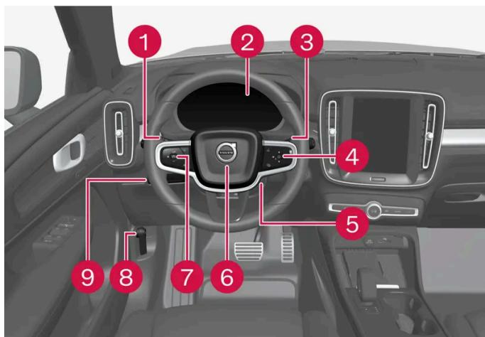
① Positionsleuchten, Tagfahrlicht, Abblendlicht, Fernlicht, Blinker, Nebelscheinwerfer/Kurvenlicht\*, Nebelschlussleuchte, Zurücksetzen des Tageskilometerzählers
