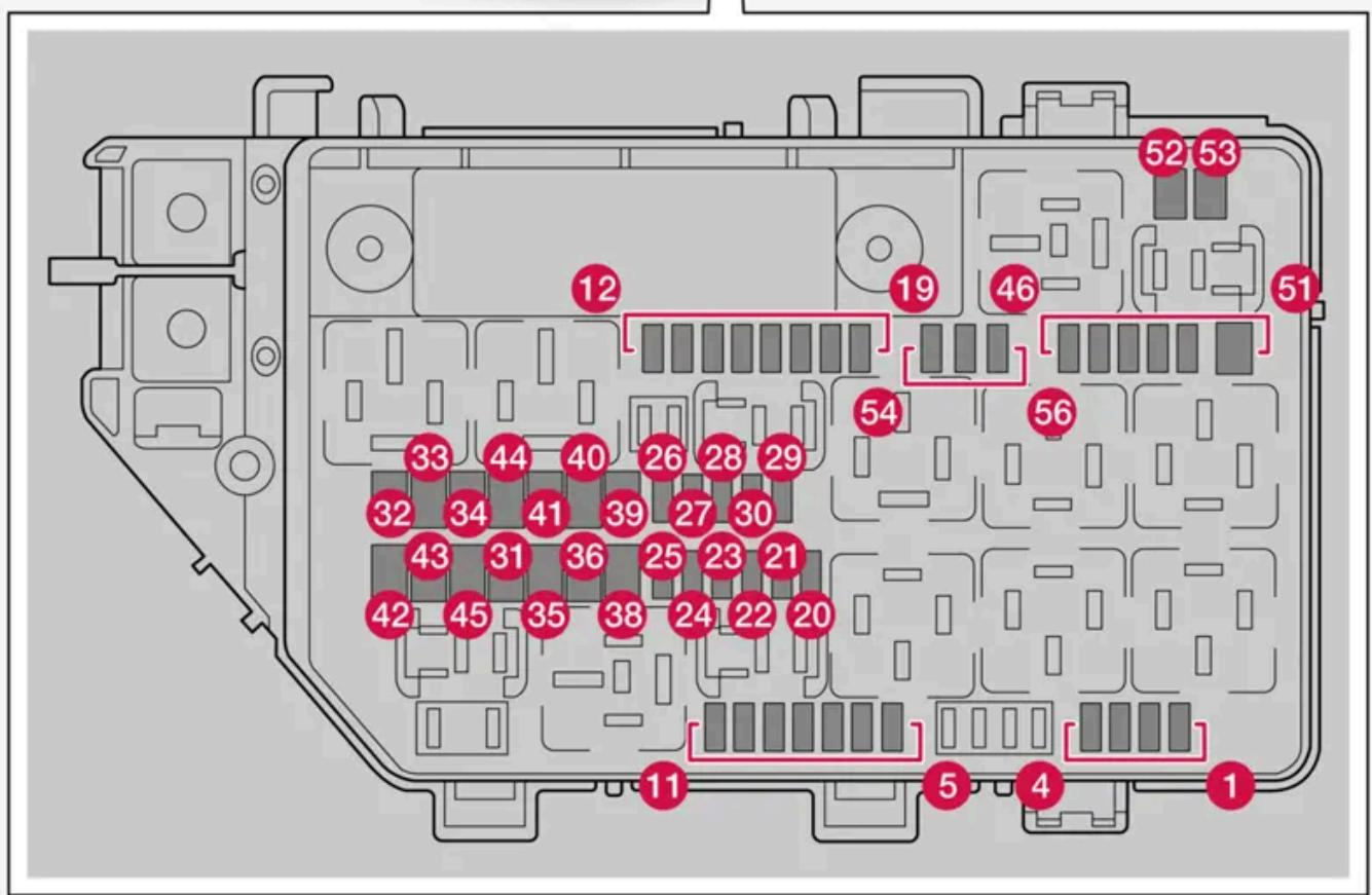
Um an die Sicherungen unter der Frontklappe zu kommen, müssen mehrere Verkleidungen im Bereich des Staufachs abgenommen werden.
