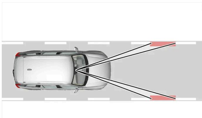
Driver Alert erfasst die Platzierung des Fahrzeug auf der Fahrbahn.
