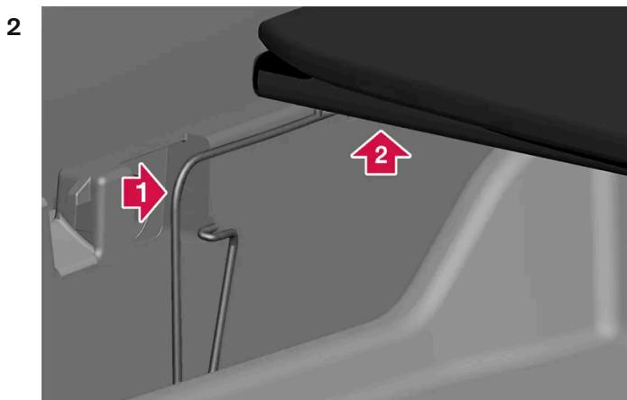
1 Drücken Sie die Sperrfeder bis zum Anschlag (Pfeil). Nicht loslassen, sondern Druck beibehalten.
