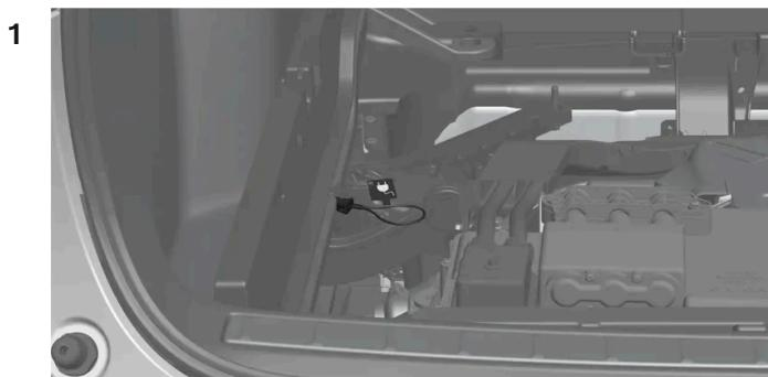
Öffnen Sie den Gepäckraum des Fahrzeugs und klappen Sie den Ladeboden hoch. Heben Sie die versenkte Bodenabdeckung heraus.
