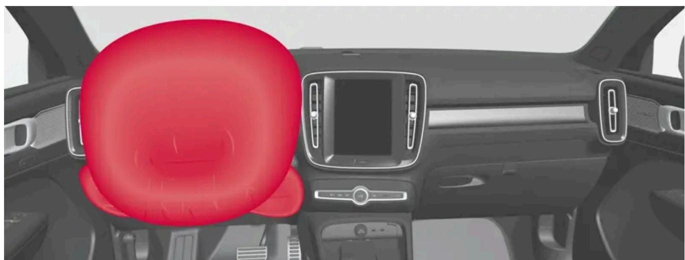
Lenkrad-Airbag und Knie-Airbag <sup>[1]</sup> am Fahrersitz.
