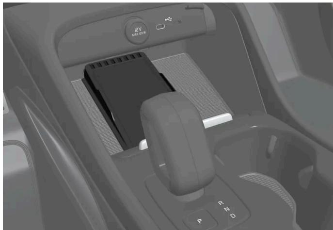
Induktives Ladesystem unter dem Center Display.
