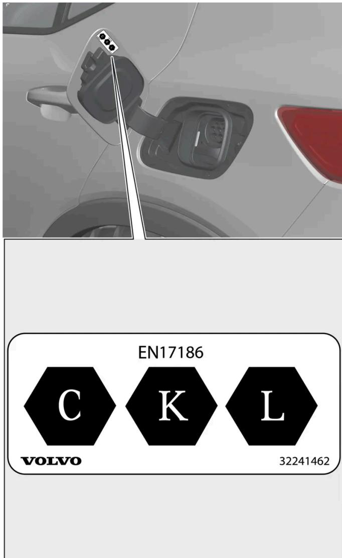
Die Kennzeichnung gemäß CEN Norm EN 17186 befindet sich auf der Innenseite der Abdeckung des Ladeanschlusses.
