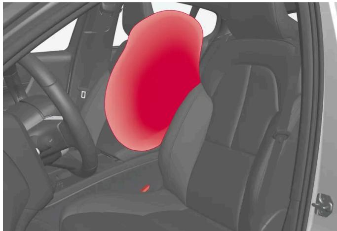
Die inneren Seitenairbags sind im Innenrahmen der Rückenlehnen montiert und helfen, Fahrer und Beifahrer in den Vordersitzen zu schützen. Der Sitz trägt die Kennzeichnung AIRBAG.
