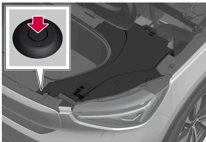
Positionen der Stopfen von Abdeckung D. Abdeckung E ist im Vergleich zu Abdeckung D spiegelverkehrt.
