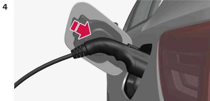
Schutzkappe des Ladestutzens abnehmen und den Ladestutzen bis zum Anschlag in die Ladebuchse einführen.
