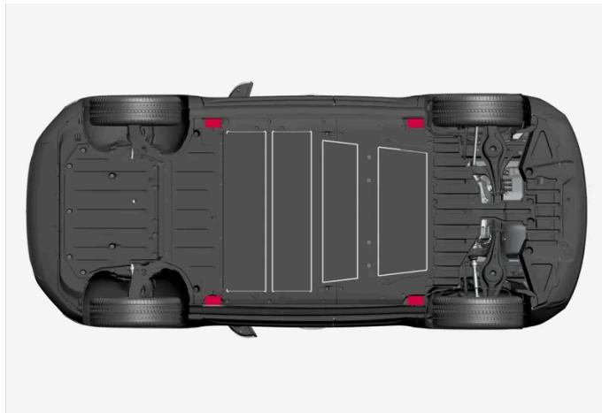
Ansatzpunkte des Fahrzeugs zum Anheben mit einem Wagenheber.
