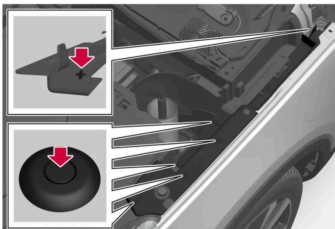
Positionen der Stopfen von Abdeckung B. Abdeckung C ist im Vergleich zu Abdeckung B spiegelverkehrt.
