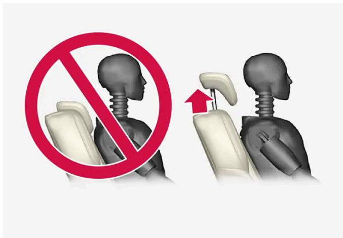
Passen Sie die Kopfstütze des mittleren Rücksitzes so an die Körpergröße an, dass nach Möglichkeit der ganze Hinterkopf aufliegt. Die Kopfstütze manuell in die gewünschte Höhe schieben.
