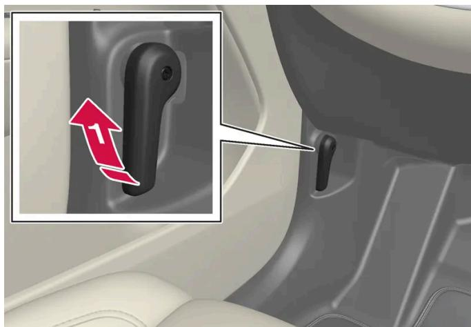
1 Am Griff neben den Pedalen ziehen, um die Frontklappe aus der vollständig geschlossenen Stellung zu lösen.
