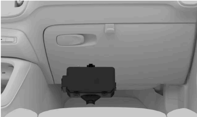
Lage des Sicherungskastens
