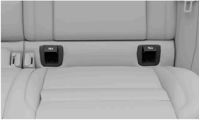
Lage der ISOFIX-Verankerungspunkte an den äußeren Rücksitzen
