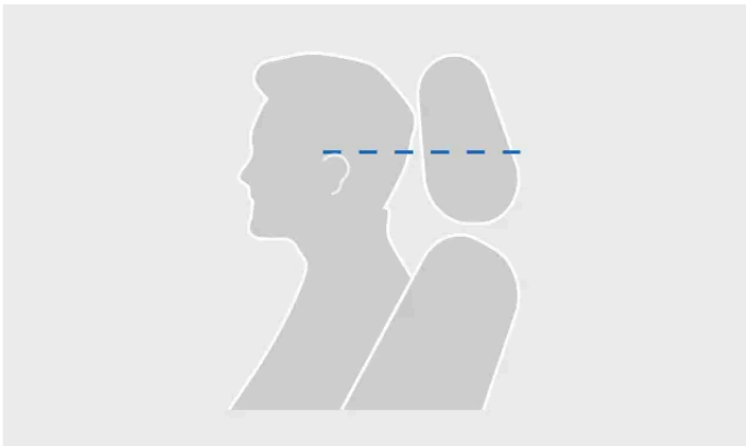
Die korrekte Höhe der Kopfstütze
