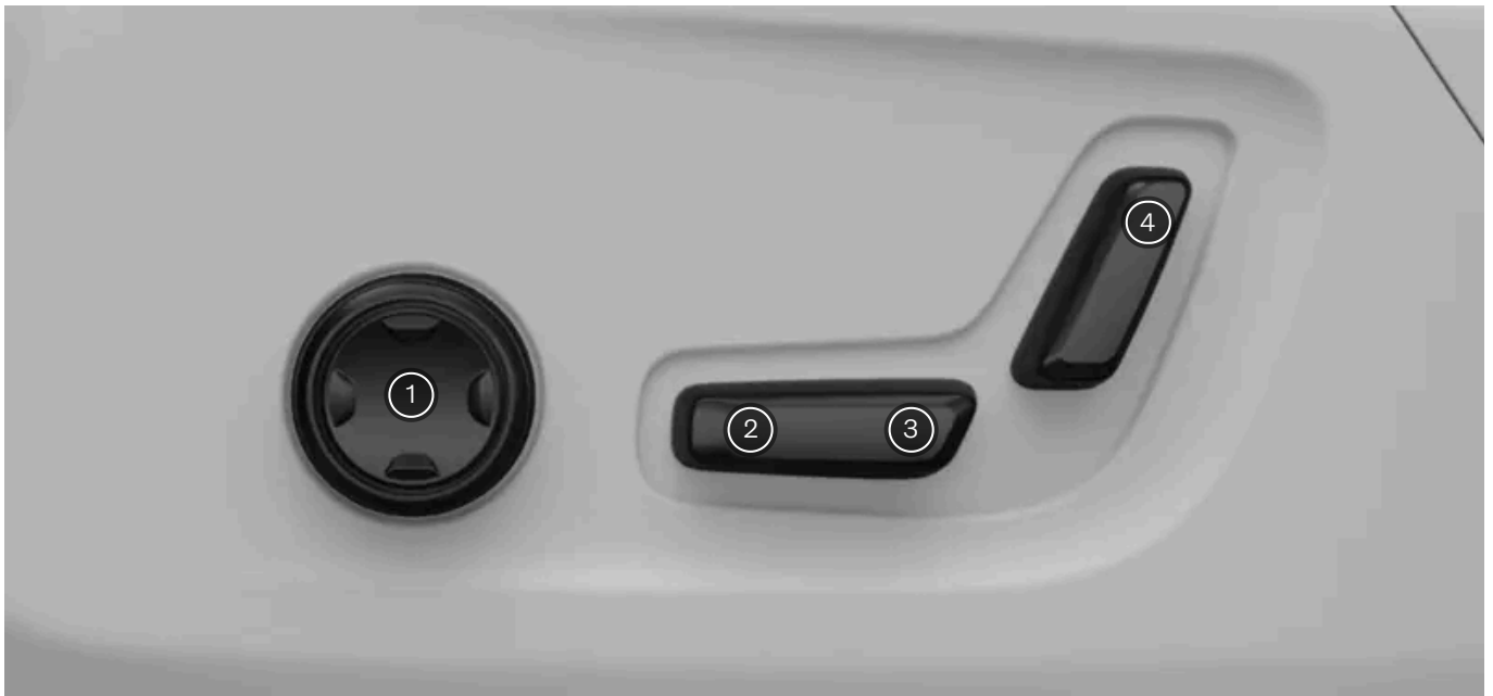
Bedienelemente an der Seite des Sitzes
