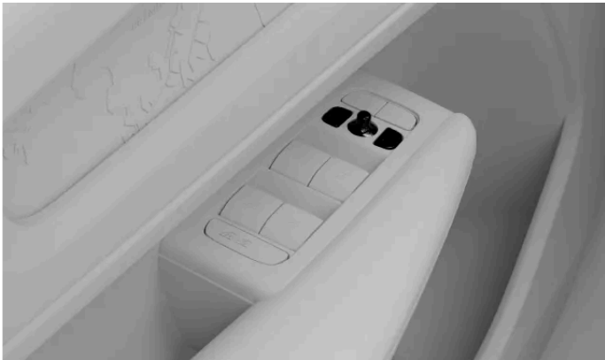
Bedienelemente zum Einstellen der Außenspiegel
