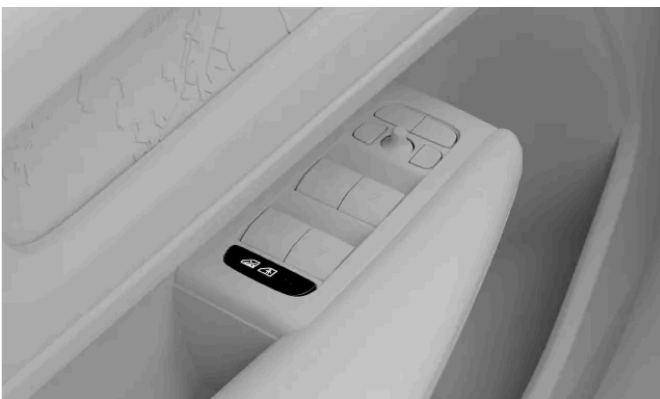
Position der Kindersicherungstaste in der Türverkleidung
