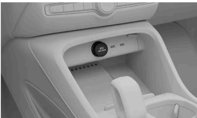
Die 12-V-Steckdose in der Tunnelkonsole
