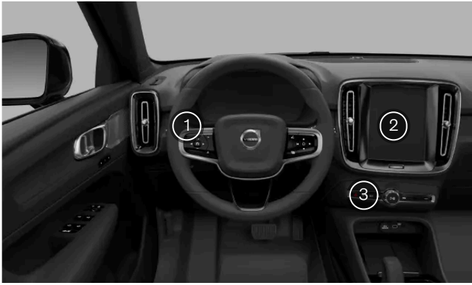
Lage der Bedienelemente für die Außenbeleuchtung
