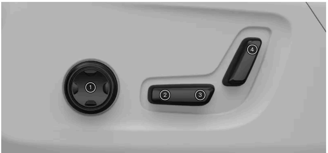
Bedienelemente an der Seite des Sitzes
