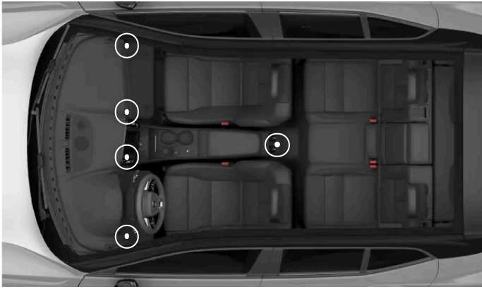
Lage der verstellbaren Lüftungsdüsen
