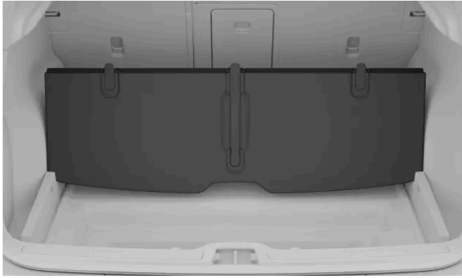
Trennwand im Kofferraum.
