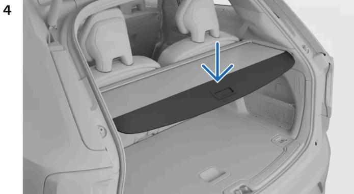
Kippen Sie die Außenkante der Laderaumabdeckung nach unten, sodass sie in den Vertiefungen einrastet.
