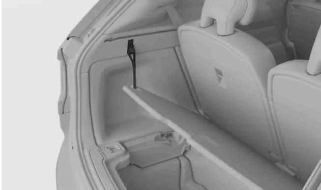
Die offene Bodenklappe lässt sich mit dem Band am Taschenhaken sichern.
