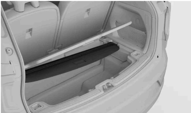
Setzen Sie das rechte Ende der Laderaumabdeckung in die Halterung ein, die sich auf der rechten Seite des Bodenstufachs befindet.
