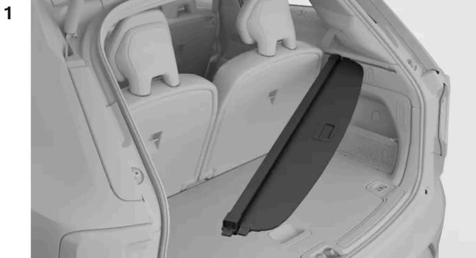
Setzen Sie ein Ende der Laderaumabdeckung in die Vertiefung auf der entsprechenden Seite des Kofferraums ein. Die Vertiefung ist mit einer Linie markiert. Richten Sie das Ende der Abdeckung an der Markierungslinie aus.
