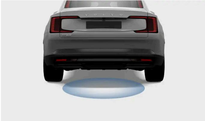
Der Sensor erfasst Bewegungen unter dem Heckstoßfänger. Dabei führt jede erfasste Bewegung zum Entriegeln der Heckklappe.
