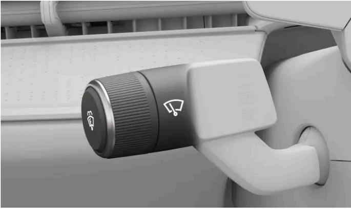
Sie bedienen die Scheibenwischer und -waschanlage mit dem Stellrad und der Taste am linken Lenkradhebel.
