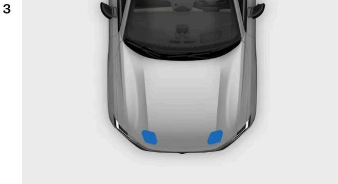
Stelle an der Frontklappe, an der sie zum Schließen heruntergedrückt wird
