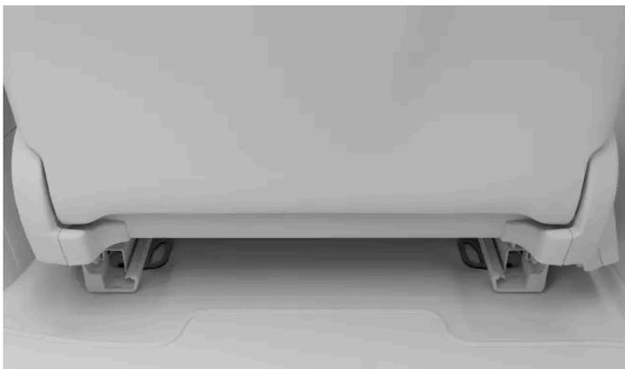
Die unteren Verankerungspunkte befinden sich hinten an den Bodenschienen der Vordersitze.
