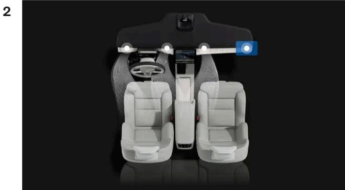
Tippen Sie auf die Lüftungsdüse, die Sie öffnen oder schließen möchten.
