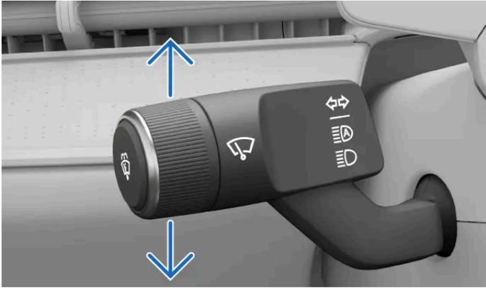
Sie können die Blinker mit dem linken Lenkradhebel bedienen.
