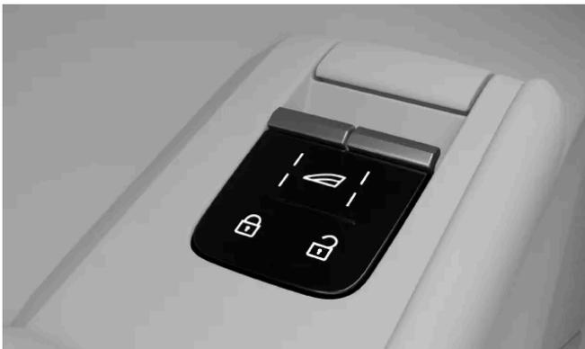
Drücken Sie auf das Fenstersymbol
