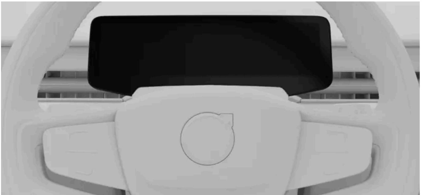
Das Fahrerdisplay befindet sich hinter dem Lenkrad. Wenn Sie das Lenkrad einstellen, wird auch die Position des Fahrerdisplays entsprechend angepasst.
