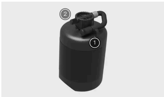
Übersicht über die Dichtmittelflasche des Reifenpannen-Sets
