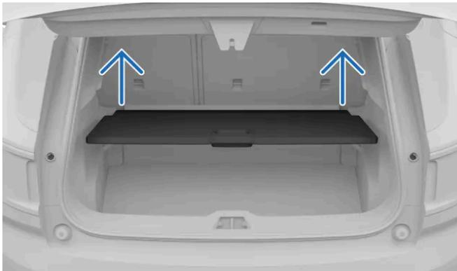
Abbildung zum Herausnehmen der Bodenklappe im Kofferraum.
