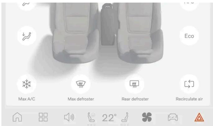
Die Lage der Schaltfläche für die Warnblinkanlage auf dem Display
