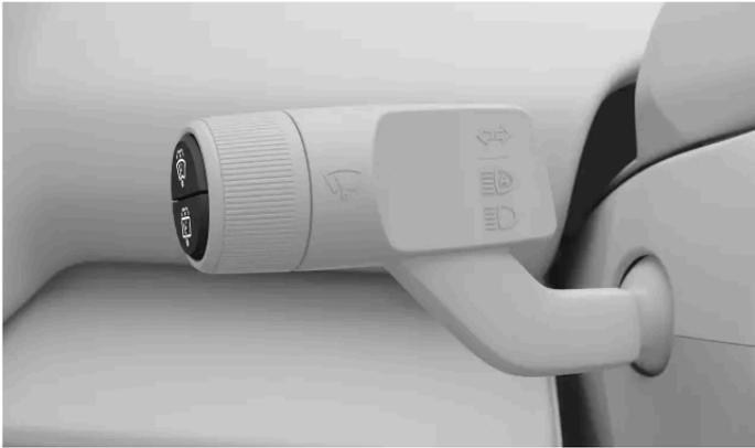
Tasten für die Scheibenwaschanlage am linken Lenkradhebel.
