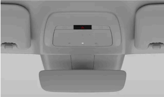
Die Lage der Taste für die Warnblinkanlage an der Deckenkonsolle
