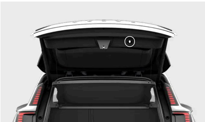
Lage der Taste zum Schließen der Heckklappe.
