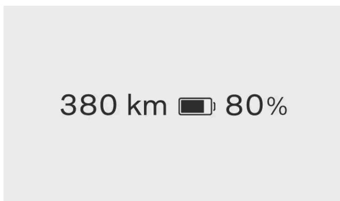
Die Batterieanzeige ist jederzeit im Displaybereich für die Fahrerinformationen sichtbar. Die Farbe des Batteriesymbols ändert sich je nach Ladezustand der Batterie.
