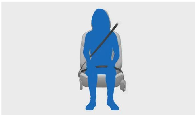
Unter bestimmten Bedingungen rastet der Sicherheitsgurt automatisch ein, um seine Funktion als Rückhaltesystem zu erfüllen. Dies ist z. B. der Fall, wenn jemand plötzlich und ruckartig am Gurt zieht, aggressiv gefahren wird oder sich das Fahrzeug auf einem steilen Gefälle befindet.
