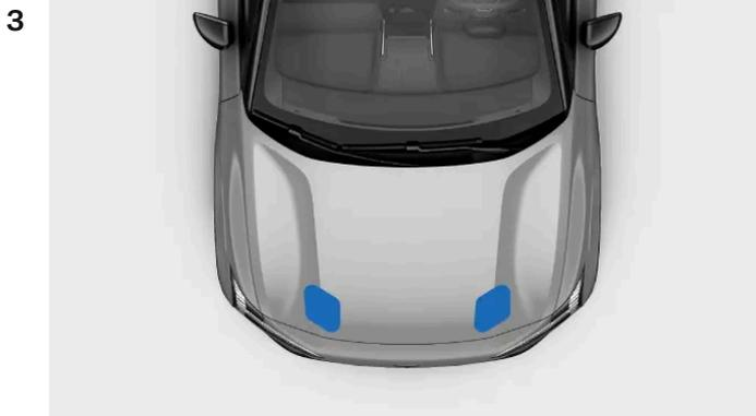
Drücken Sie die Frontklappe an der Vorderkante mit beiden Händen herunter. Kontrollieren Sie, dass die Sperrriegel der Frontklappe gleichzeitig einrasten. Halten Sie die Vorderkante beim Schließen gerade.
