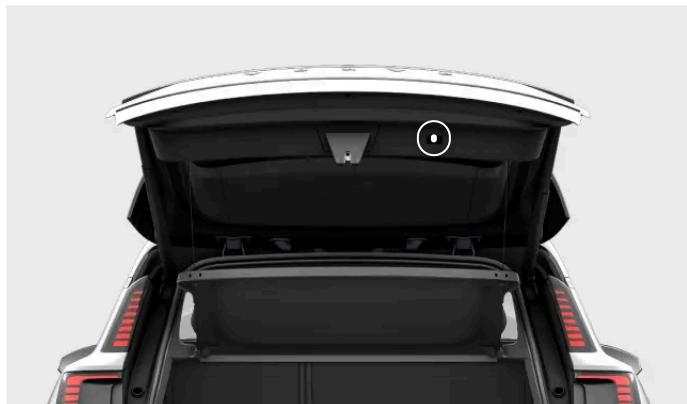
Lage der Taste zum Schließen der Heckklappe.
