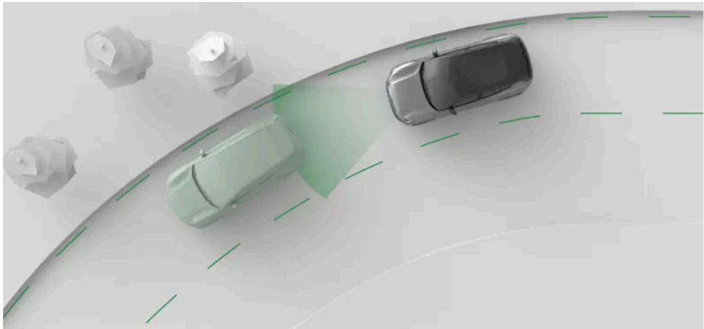
Pilot Assist unterstützt Sie auf unterschiedliche Weise aktiv beim Fahren. Wenn Sie mit Pilot Assist fahren, stellen Sie die Sollgeschwindigkeit ein. Das Fahrzeug beschleunigt und bremst so, dass die Sollgeschwindigkeit erreicht wird, Sie aber auch im fließenden Verkehr „mitschwimmen“.
