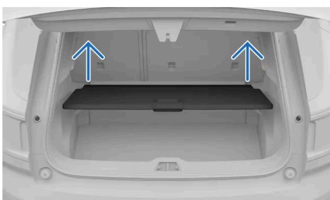
Abbildung zum Herausnehmen der Bodenklappe im Kofferraum.
