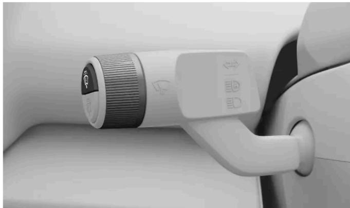
Mit dem linken Hebel aktivieren Sie die verschiedenen Frontwischermodi. Folgende Modi stehen zur Verfügung:
