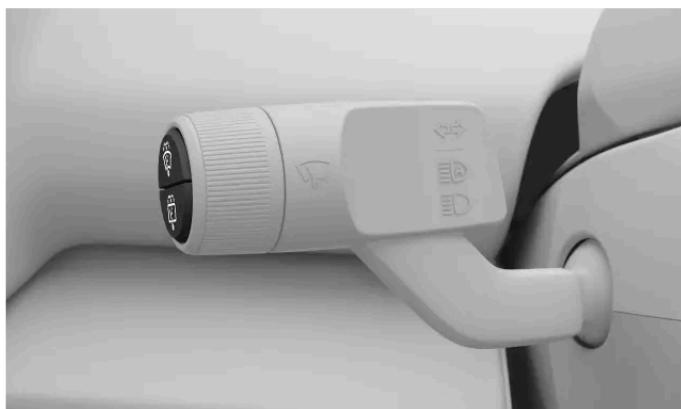
Tasten für die Scheibenwaschanlage am linken Lenkradhebel.
