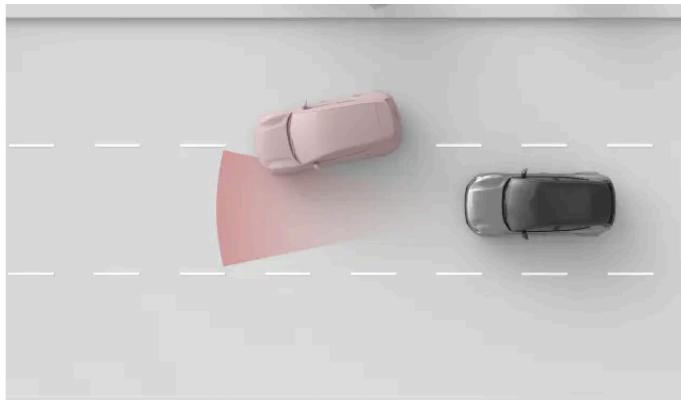
Der Erfassungsbereich des vorderen Radars hat eine begrenzte Breite. Wenn Sie von einem anderen Fahrzeug geschnitten werden, kann die Erkennung relativ spät erfolgen und zu einer plötzlichen Reaktion des Fahrzeugs führen.
