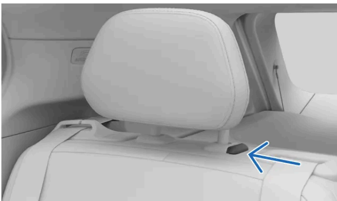
Verriegelungstaste an der Kopfstütze
