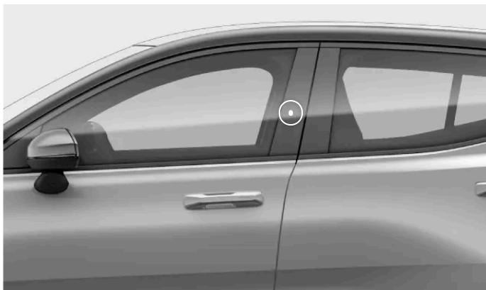
Schlüsselerkennungsbereich an der Fahrertürsäule.
