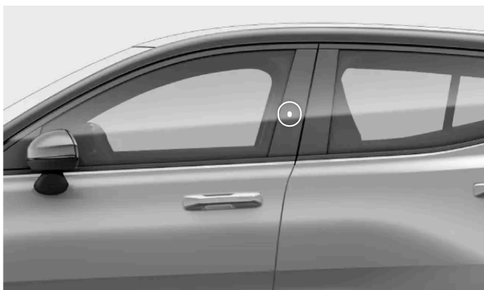
Schlüsselerkennungsbereich an der Fahrertürsäule.
