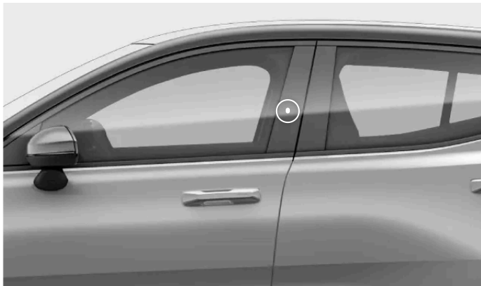
Schlüsselerkennungsbereich an der Türsäule
