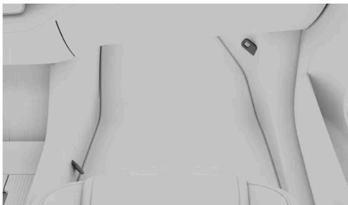
Bei Ausstattung mit dem Zubehör für den unteren Haltegurt<sup>[1]</sup> befinden sich die unteren Verankerungspunkte an den Seiten des Beifahrerfußraums.
