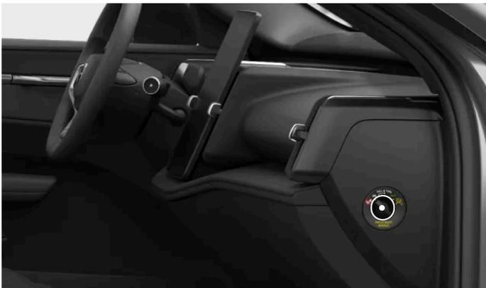
Der Airbagschalter befindet sich seitlich am Armaturenbrett und ist bei geöffneter Beifahrertür zugänglich.
