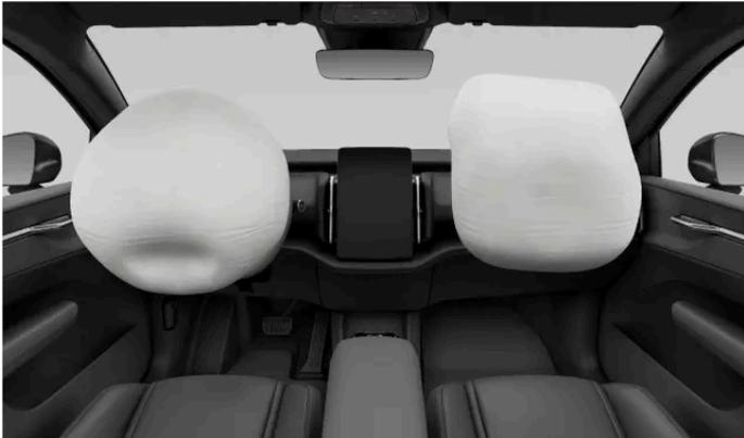
Der Fahrerairbag ist im Inneren des Lenkrads untergebracht.
