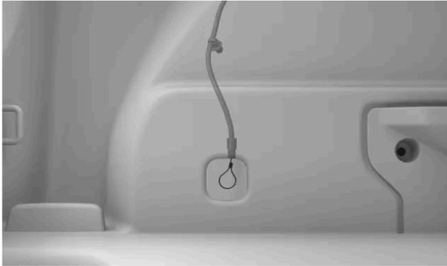
➤ Die Verriegelung des Ladekabels in der Ladebuchse wird aufgehoben.
