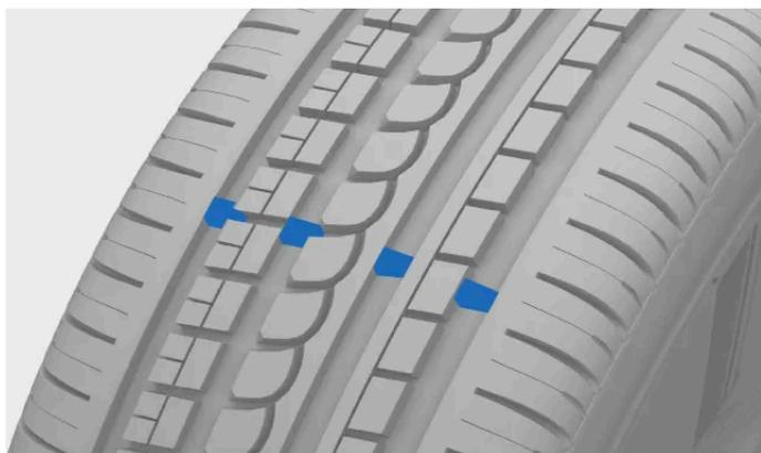
Der Verschleiß wird mithilfe der schmalen Rillen angezeigt, die längs über das Reifenprofil verlaufen. An der Reifenflanke finden sich die Buchstaben TWI [1].
