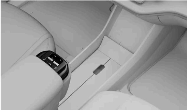
Von den Vordersitzen aus können Sie alle Fensterheber bedienen. Drücken Sie die Taste mit dem Text REAR, um zwischen den vorderen und hinteren Fenstern zu wechseln. Wenn die hinteren Fenster ausgewählt sind, leuchtet die Taste gelb. Wenn Sie die Taste erneut drücken oder einige Sekunden lang nichts tun, wechselt das Tastenfeld wieder zu den vorderen Fenstern.
