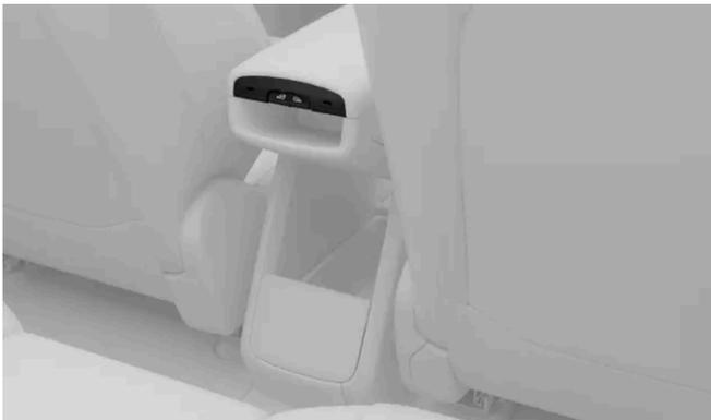
Im Fond können Sie die hinteren Fenster über die Tasten bedienen, die sich am hinteren Ende der mittleren Armlehne befinden.
