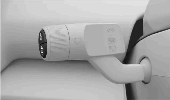
Tasten für die Scheibenwaschanlage am linken Lenkradhebel.
