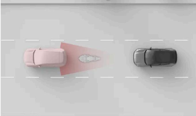
Das kleinere Motorrad und das Fahrzeug sind nahe beieinander und überlappen sich. Dadurch wird die Erkennung des Motorrads ungenauer.
