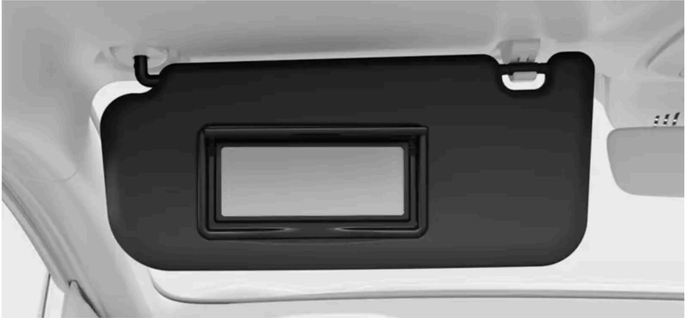
Die Sonnenblenden lassen sich herunterklappen und zur Seite schwenken, um die seitliche Sonneneinstrahlung abzuhalten.
