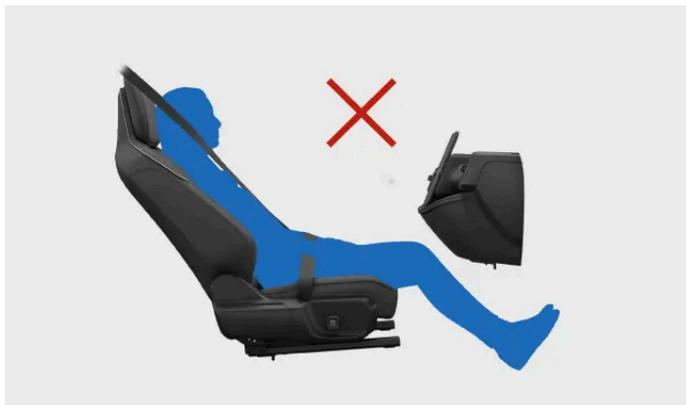
Bringen Sie die Rückenlehne nicht in eine liegende Position. Der Sicherheitsgurt muss gespannt über der Schulter liegen.
