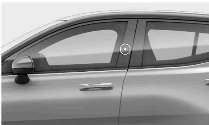
Schlüsselerkennungsbereich an der Fahrertürsäule.
