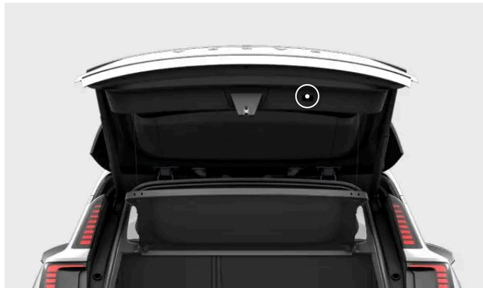
Lage der Taste zum Schließen der Heckklappe.
