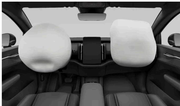
Der Fahrerairbag ist im Inneren des Lenkrads untergebracht.
