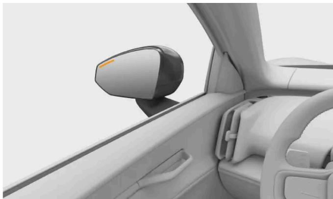
Wenn die Funktion ein Fahrzeug erkennt, das in kurzem Abstand am eigenen Fahrzeug vorbeifahren wird, schaltet sich eine Außenspiegelleuchte ein und erscheint eine Meldung auf dem Display. Wenn Sie dann beginnen, auf der Seite mit dem erkannten Fahrzeug die Tür zu öffnen, verstärkt sich die Warnung. Je nachdem, wie dringend die Warnung ist, kann zu den optischen Signalen ein Warnton hinzukommen.
