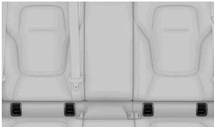
Die ISOFIX-Verankerungspunkte im Fond befinden sich unter einer Klappe im unteren Teil der Rückenlehnen der äußeren Rücksitze. Sie müssen die Klappe öffnen, um an die dahinterliegenden Verankerungspunkte zu kommen.
