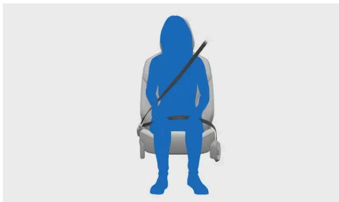
Unter bestimmten Bedingungen rastet der Sicherheitsgurt automatisch ein, um seine Funktion als Rückhaltesystem zu erfüllen. Dies ist z. B. der Fall, wenn jemand plötzlich und ruckartig am Gurt zieht, aggressiv gefahren wird oder sich das Fahrzeug auf einem steilen Gefälle befindet.
