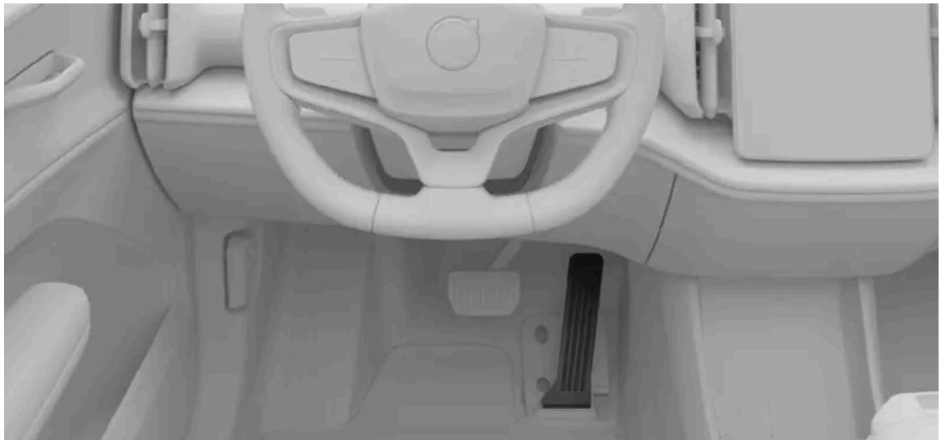
Je nachdem, wie Sie das Fahrpedal betätigen, ändert sich das Bremsverhalten. Beim Betätigen des Fahrpedals beschleunigt das Fahrzeug wie gewohnt, aber wenn Sie das Fahrpedal loslassen, wird stattdessen gebremst. Je weniger Sie das Pedal betätigen, desto stärker ist die Bremswirkung.
