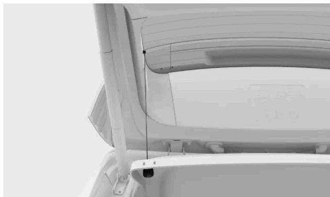
1 Lösen Sie die Haltebänder von den Befestigungspunkten am Kofferraumdeckel.
