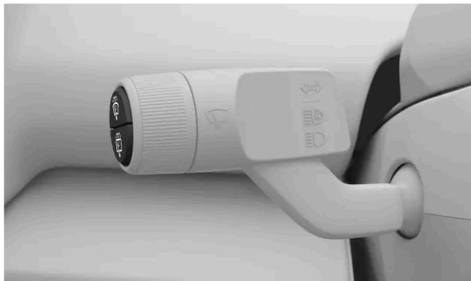
Tasten für die Scheibenwaschanlage am linken Lenkradhebel.
