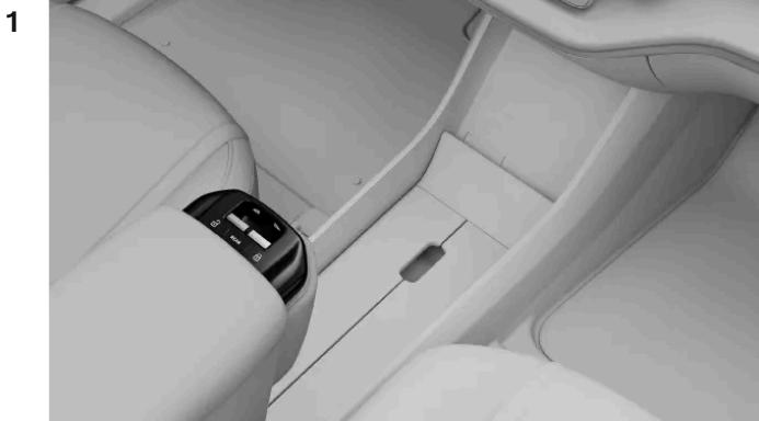
Von den Vordersitzen aus können Sie alle Fensterheber bedienen. Drücken Sie die Taste mit dem Text REAR, um zwischen den vorderen und hinteren Fenstern zu wechseln. Wenn die hinteren Fenster ausgewählt sind, leuchtet die Taste gelb.
