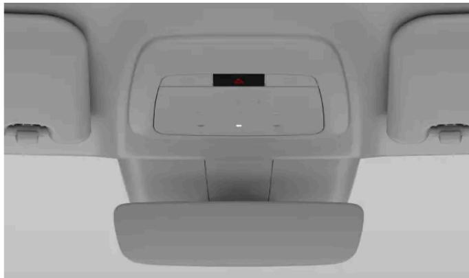
Die Lage der Taste für die Warnblinkanlage an der Deckenkonsole
