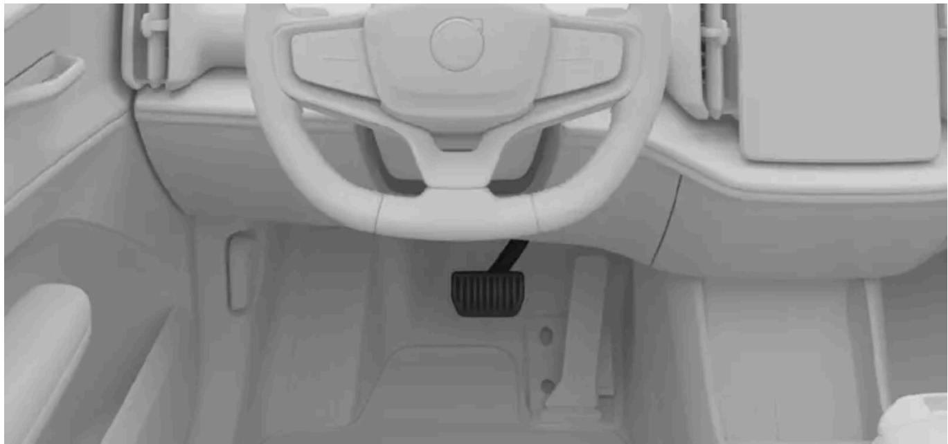
Je nachdem, wie fest Sie das Pedal treten, aktiviert die Betriebsbremse entweder die Bremsenergierückgewinnung oder betätigt die Reibungsbremse. Leichtes Bremsen aktiviert die Bremsenergierückgewinnung, stärkeres Bremsen betätigt die Friktionsbremsen.
