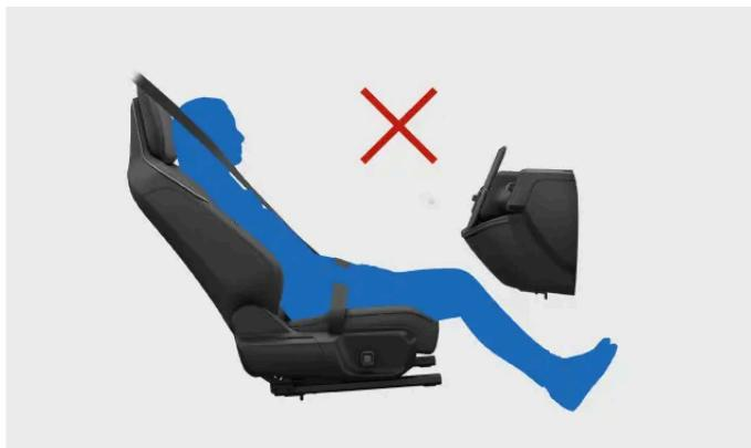
Bringen Sie die Rückenlehne nicht in eine liegende Position. Der Sicherheitsgurt muss gespannt über der Schulter liegen.
