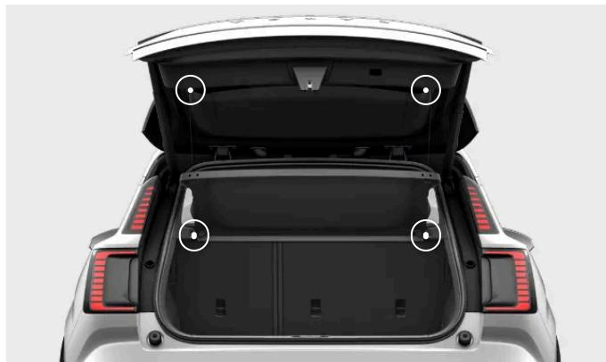
Es befinden sich je zwei Befestigungspunkte an der Heckablage selbst und an der Heckklappe. Die Heckablage ist mit Haltebändern angebracht, die zwischen den Befestigungspunkten an der Heckablage selbst und am Kofferraumdeckel verlaufen.
