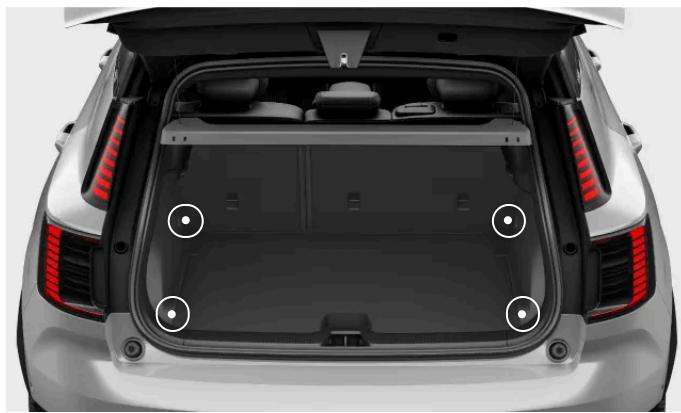
In allen vier Ecken des Kofferraums befinden sich Lastsicherungsösen. An den Lastsicherungsösen lassen sich Gurte befestigen und Ladungsgegenstände im Kofferraum sichern.
