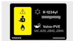
Der Aufkleber mit den Angaben zu den Flüssigkeiten in der Klimaanlage ist rechts unter der Frontklappe angebracht.
