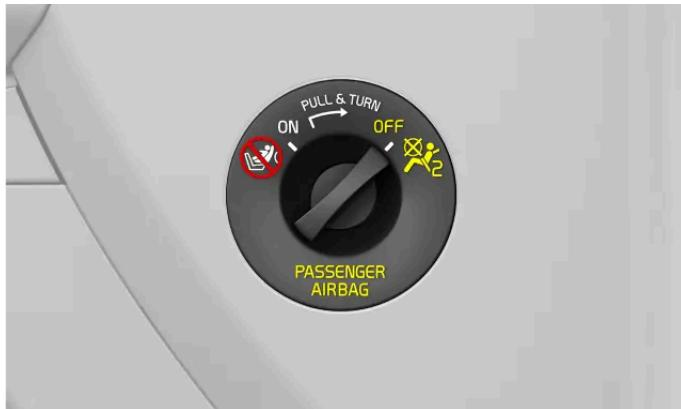
Deaktivierter Airbag. In dieser Stellung muss der Schalter immer dann stehen, wenn auf dem Beifahrersitz ein Kind mit dem Gesicht gegen die Fahrtrichtung mitfährt, also in einem rückwärtsgerichteten Kinderrückhaltesystem.
