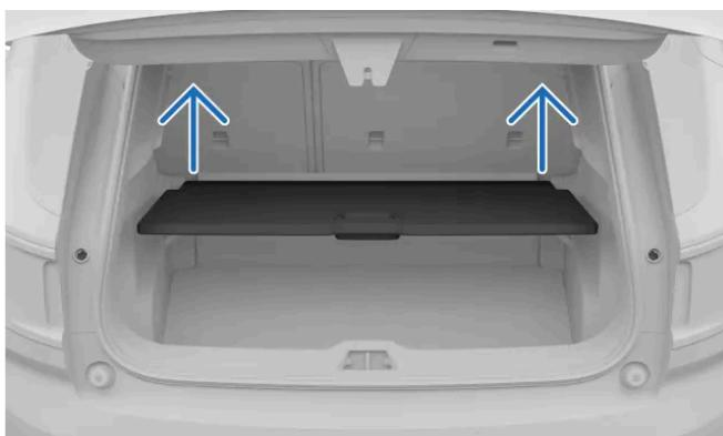
Abbildung zum Herausnehmen der Bodenklappe im Kofferraum.
