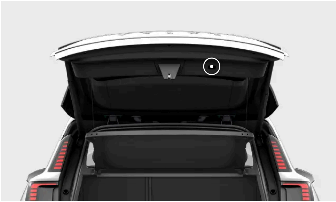
Lage der Taste zum Schließen der Heckklappe.
