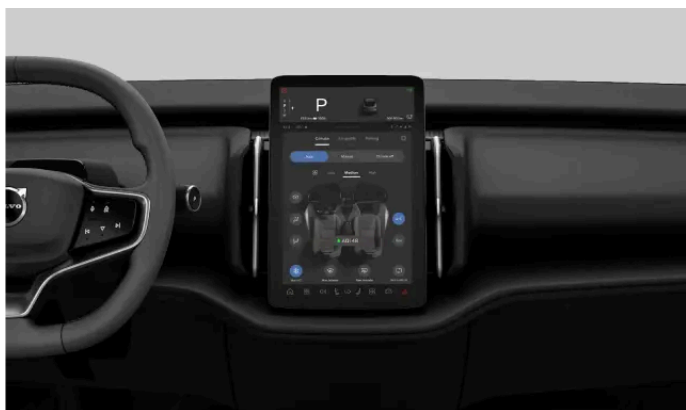
Bedienelemente der Klimaanlage auf dem Display
