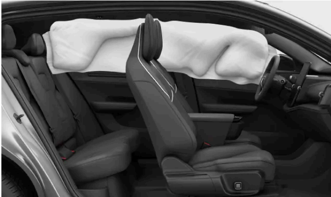
Auf einer Seite des Fahrzeugs ausgelöster Kopf-/Schulterairbag.
