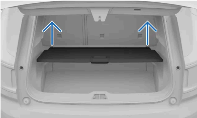
Abbildung zum Herausnehmen der Bodenklappe im Kofferraum.
