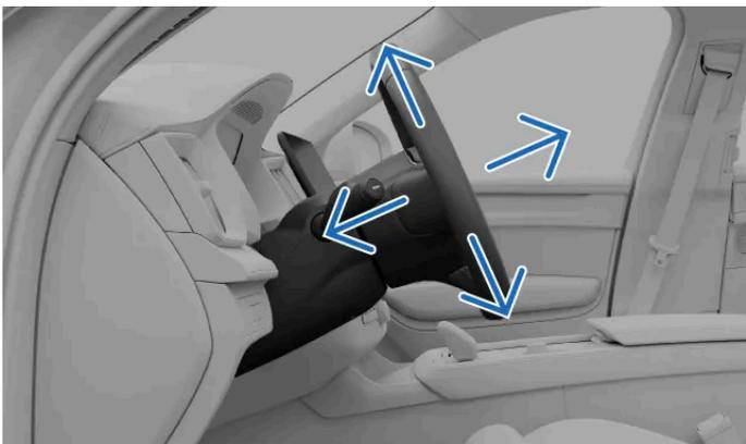
Die richtige Lenkradposition ist von entscheidender Bedeutung dafür, dass Sie möglichst bequem sitzen und das Fahrzeug optimal unter Kontrolle haben.
