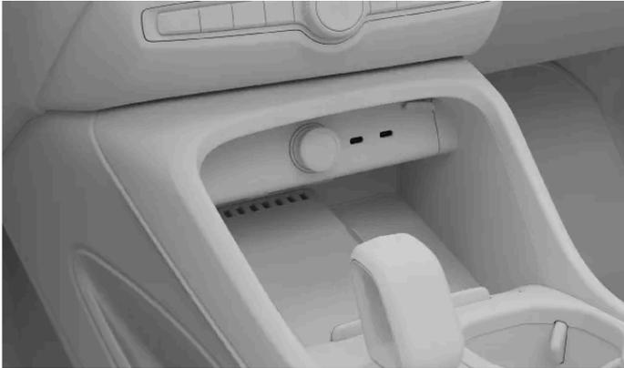
Zwei weitere USB-Buchsen sind im hinteren Bereich der Tunnelkonsole untergebracht.
