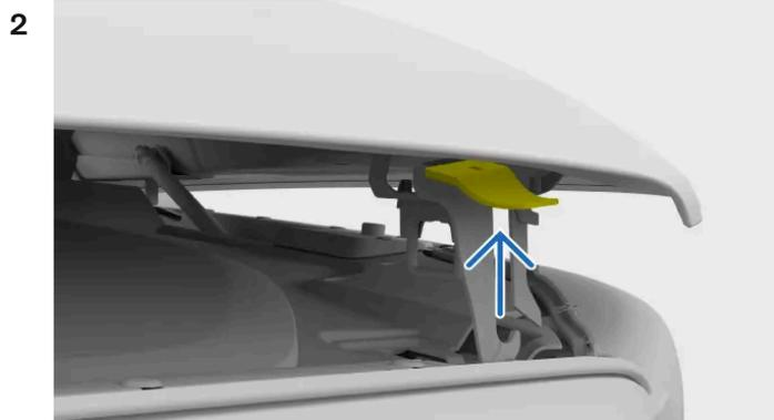
2 Ertasten Sie den zweiten Hebel an der Unterseite der Frontklappe und drücken Sie ihn nach oben.
