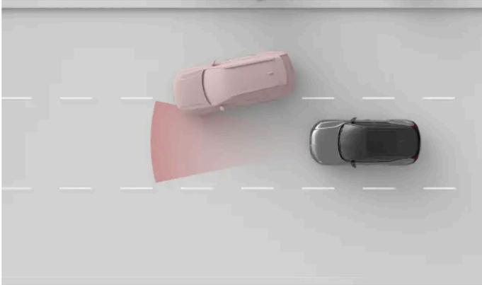
Der Erfassungsbereich des vorderen Radars hat eine begrenzte Breite. Wenn Sie von einem anderen Fahrzeug geschnitten werden, kann die Erkennung relativ spät erfolgen und zu einer plötzlichen Reaktion des Fahrzeugs führen.
