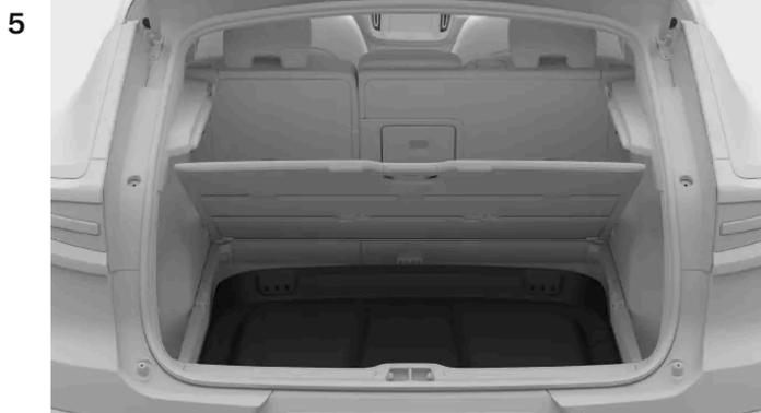
Legen Sie die Heckablage mit der Oberseite nach unten und dem hinteren Teil nach vorn ab.
