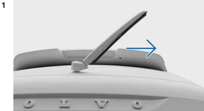
Ergreifen Sie den Wischerarm in der Mitte und heben Sie ihn von der Heckscheibe ab. Auf halbem Weg nehmen Sie ggf. einen gewissen Widerstand wahr – dies ist die Sperrstellung. Damit der Wischerarm nicht zurück auf die Scheibe fällt, müssen Sie ihn über diese Stellung hinaus von der Scheibe abheben.
