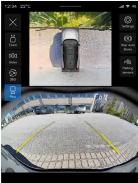
In der Parkansicht können zwei Ansichten gleichzeitig angezeigt werden. Das Bild zeigt ein Beispiel der Ansicht, wenn die Kamera-Ansicht für die Rückfahrkamera ausgewählt ist, die in der unteren Hälfte des Center Displays angezeigt wird. In der oberen Hälfte des Displays wird eine Übersicht über die Umgebung des Fahrzeugs angezeigt.
