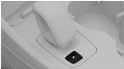
Aktivieren Sie die Feststellbremse manuell, indem Sie die Taste der Feststellbremse drücken.
