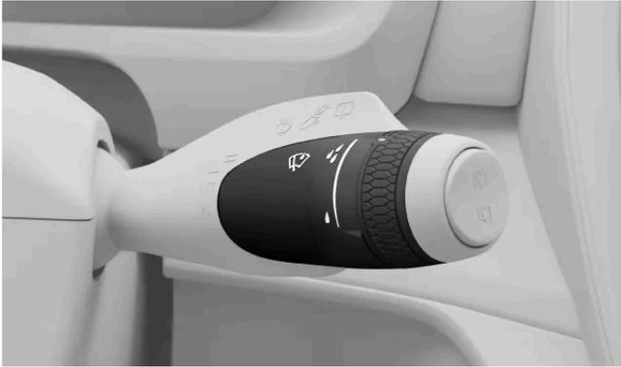
Die Bedienelemente des Frontscheibenwischer befinden sich am rechten Lenkradhebel.
