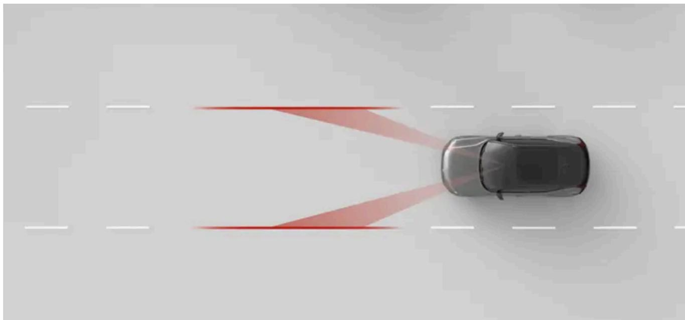
Bei aktiviertem Spurhalteassistenten kann das Fahrzeug Sie warnen, wenn Sie von der Spur abzukommen drohen, und Sie auffordern, aufmerksam zu lenken. Auch ein aktiver Lenkeingriff durch die Funktion ist möglich. Der Spurhalteassistent ist darauf angewiesen, dass die Frontkamera des Fahrzeugs die Straßenmarkierung und Ihre Position in der Spur erkennt.
