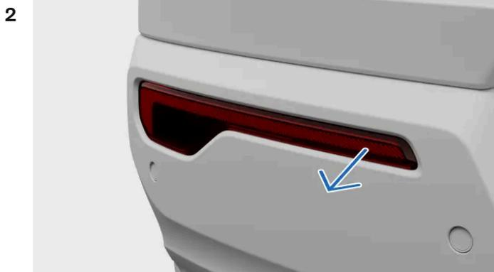
Führen Sie einen Schraubendreher hinter die schmalere kurze Seite der Nebelleuchte und hebeln Sie die Leuchte heraus.
