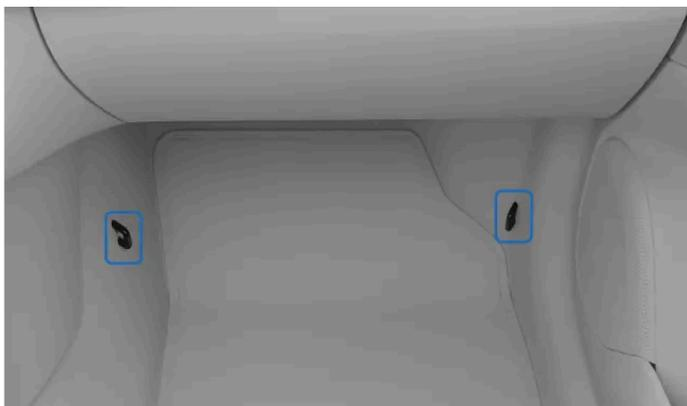
Die unteren Verankerungspunkte für den Beifahrersitz befinden sich an den Seiten des Beifahrerfußraums.
