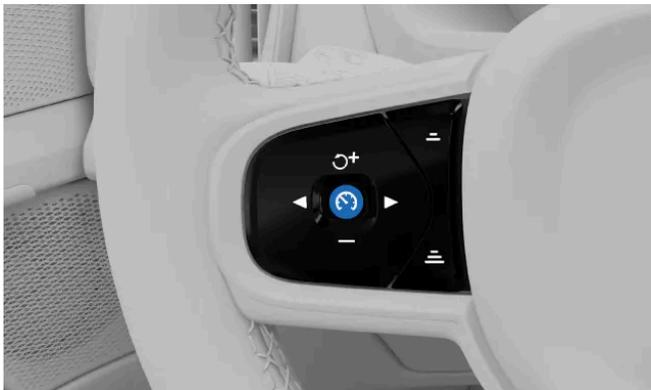
Wenn dies sicher möglich ist: Drücken Sie die Lenkradtaste für Pilot Assist
