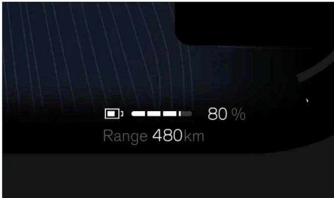
Die Reichweite hängt vor allem vom Ladezustand der Batterie und Ihrer Fahrweise ab, aber auch externe Faktoren können eine Rolle spielen. Der Ladezustand der Batterie und die voraussichtliche Reichweite werden auf dem Fahrerdisplay angezeigt. Zur Berechnung der voraussichtlichen Reichweite werden das aktuelle und frühere Fahrprofile herangezogen.
