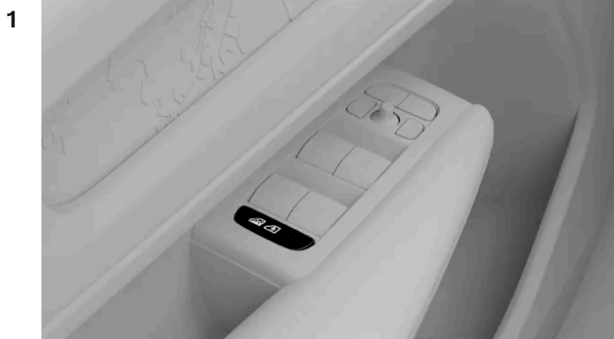
Position der Kindersicherungstaste in der Türverkleidung
