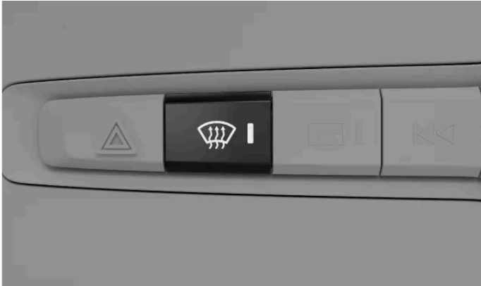
Enteisungstaste im Tastenfeld unter dem Center Display
