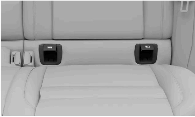
Lage der ISOFIX-Verankerungspunkte an den äußeren Rücksitzen
