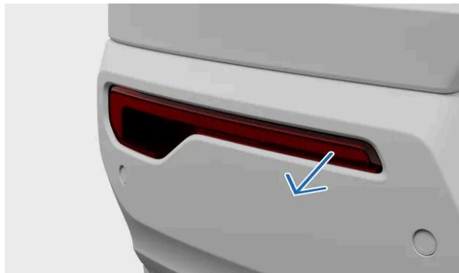
Führen Sie einen Schraubendreher hinter die schmalere kurze Seite der Nebelleuchte und heben Sie die Leuchte heraus.
