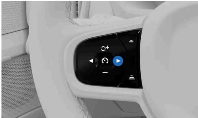
Drücken Sie die Umschalttaste ► am Lenkrad.
