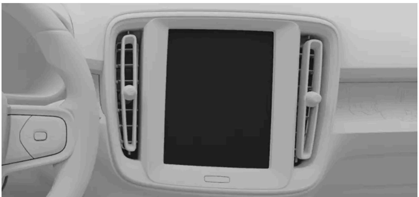
Das Center Display befindet sich in der Mitte des Armaturenbretts und schaltet sich beim Öffnen der Fahrertür automatisch ein.
