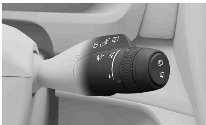
Die Scheibenwischer und die Waschanlage werden mit dem rechten Lenkradhebel bedient.
