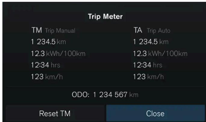
Ihr Fahrzeug verfügt über einen Tageskilometerzähler und einen Kilometerzähler. Der Tageskilometerzähler kann Informationen über die Fahrstrecke und die Fahrzeit sowie über die durchschnittliche Fahrgeschwindigkeit anzeigen.
