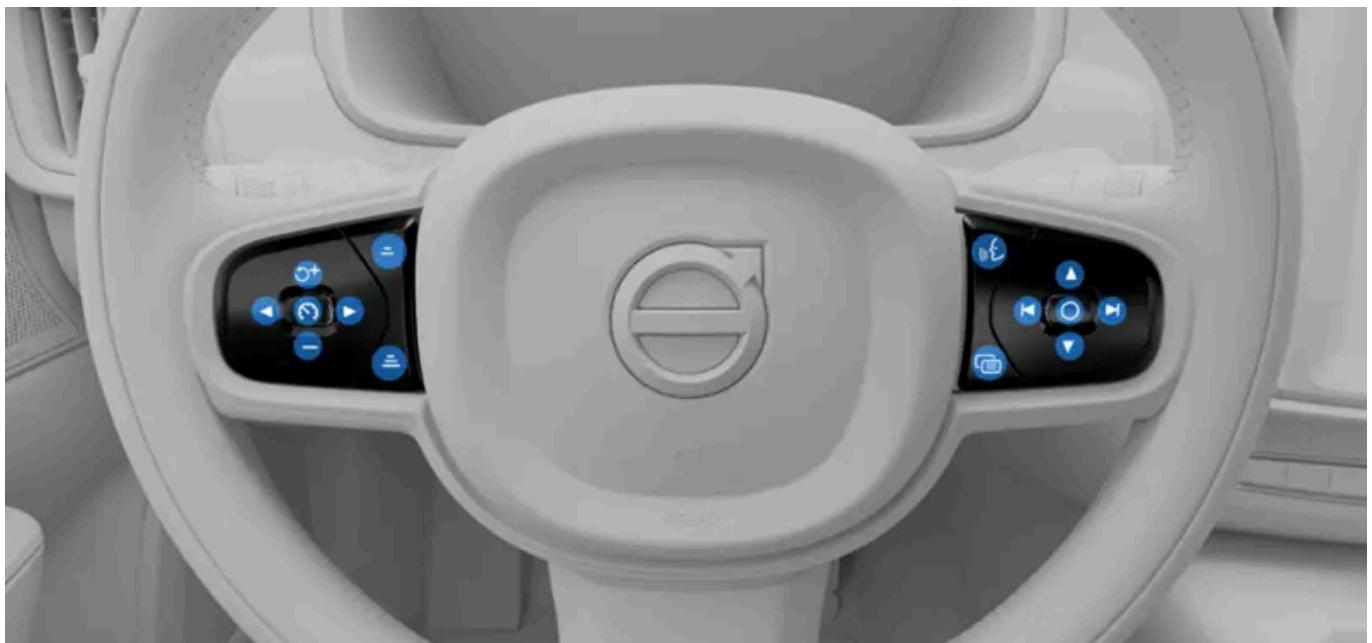
Die Bedienelemente auf der linken Seite des Lenkrads steuern Fahrerassistenzfunktionen.
