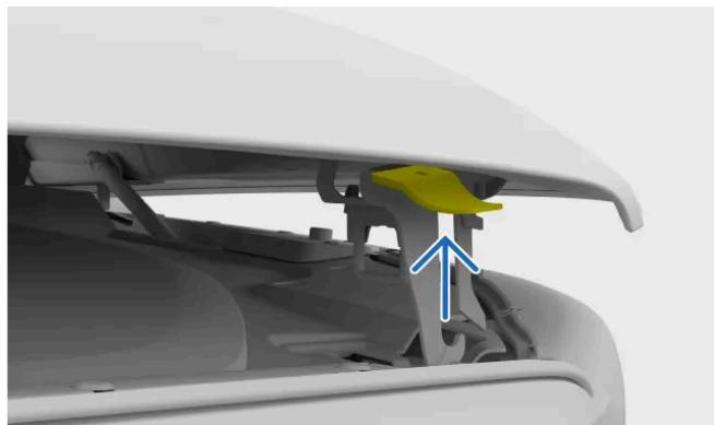
Ertasten Sie den zweiten Hebel an der Unterseite der Frontklappe und drücken Sie ihn nach oben.
