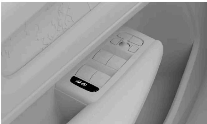
Position der Kindersicherungstaste in der Türverkleidung
