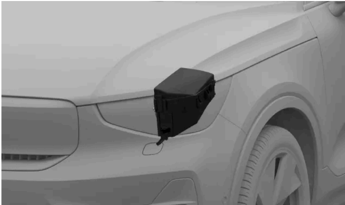
Lage des Sicherungskastens
