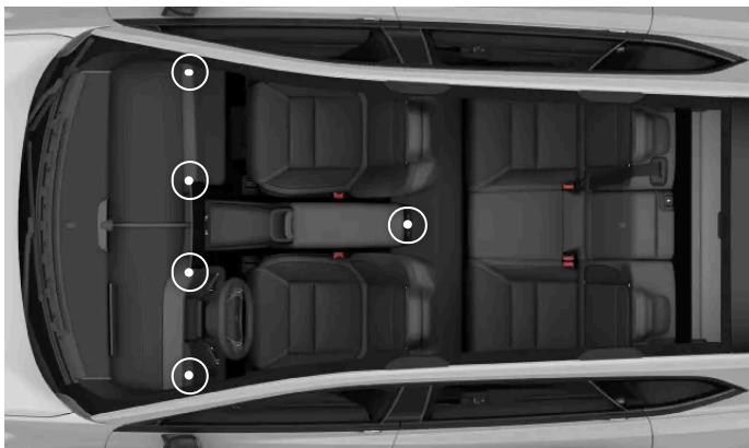
Lage der verstellbaren Lüftungsdüsen im Innenraum.
