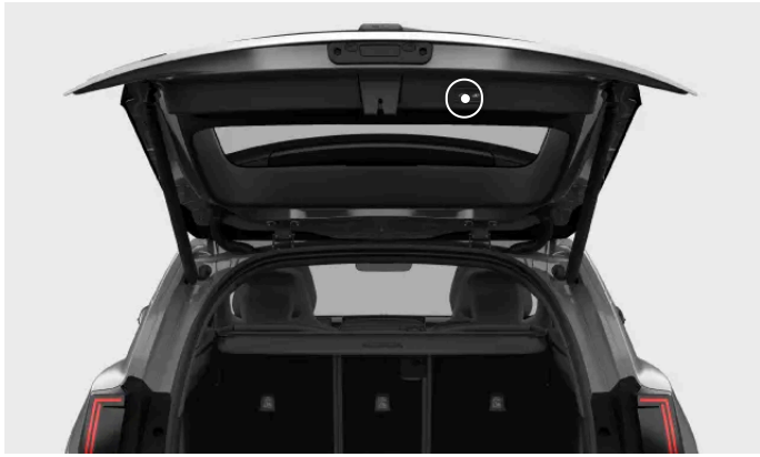
Lage der Taste zum Schließen der Heckklappe
