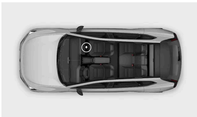
Lage der VIN am Träger unter dem Beifahrersitz
