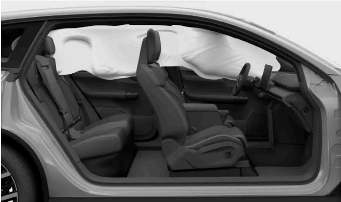
Auf einer Seite des Fahrzeugs ausgelöster Kopf-/Schulterairbag.
