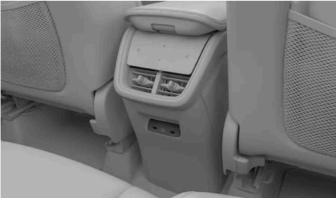
Zwei weitere USB-Buchsen <sup>[1]</sup> sind hinten an der Tunnelkonsole untergebracht.
