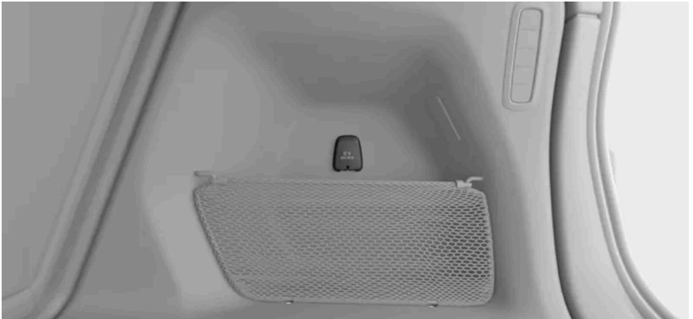
Die 12-V-Steckdose befindet sich an der rechten Kofferraumwand.
