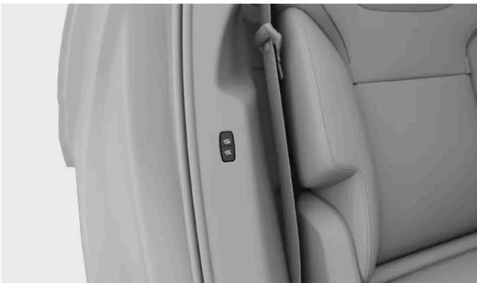
Bei geöffneten Hintertüren sehen Sie die Tasten zum Umklappen der Rückenlehnen am Türrahmen. Auf beiden Fahrzeugseiten befinden sich identische Tastenfelder. Die Bedienung über diese Tastenfelder ist besonders bequem, wenn Sie die Lehnen der zweiten und dritten Sitzreihe umklappen möchten.
