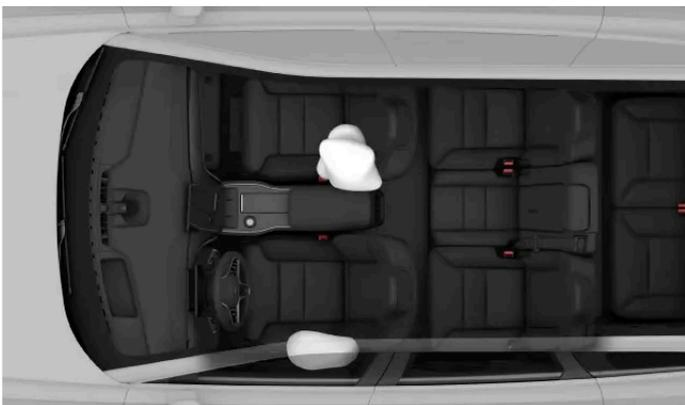
Die Seitenairbags links an den Vordersitzen zum Schutz bei einem Seitenaufprall von links. Bei einem Seitenaufprall von rechts lösen die Airbags auf der anderen Seite der Vordersitze aus.
