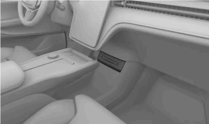
Zwei USB-Buchsen <sup>[1]</sup> befinden sich unter dem Center Display.
