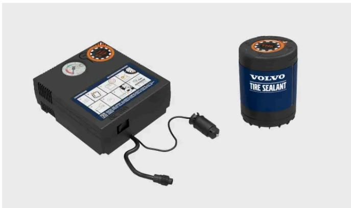
Ihr Fahrzeug ist mit einem Reifenpannen-Set ausgestattet, mit dem sich kleinere Reifenschäden provisorisch reparieren lassen.
