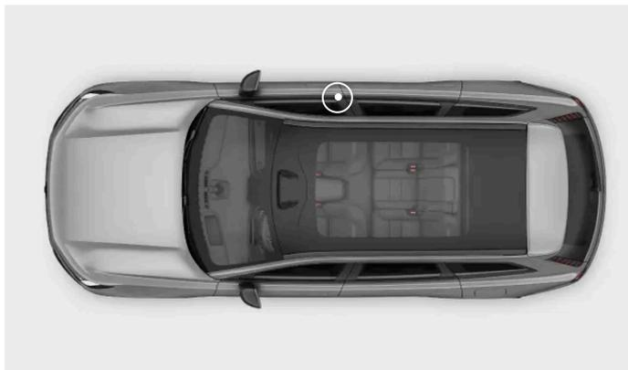
Das Typenschild befindet sich an der rechten Türsäule und ist bei geöffneter Tür sichtbar.
