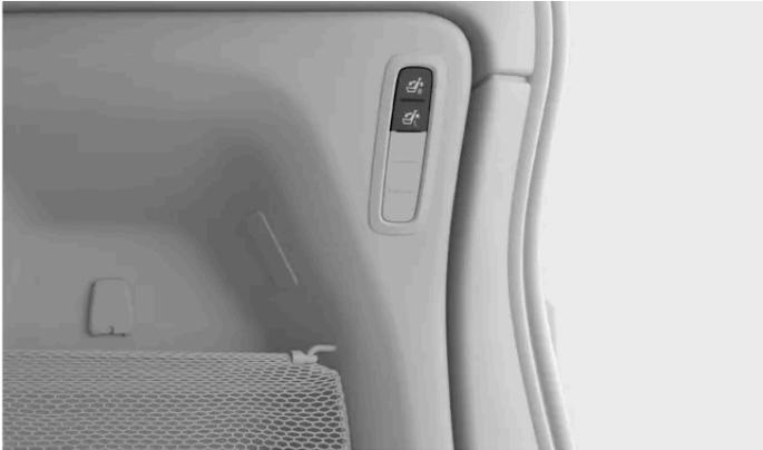
Ein Tastenfeld befindet sich rechts an der Rückenlehne im Kofferraum. Die beiden oberen Tasten erlauben das Umklappen und Aufstellen der Rückenlehne des jeweiligen Sitzes. Die Bedienung über dieses Tastenfeld ist besonders praktisch, wenn Sie während des Beladens mehr Platz brauchen.
