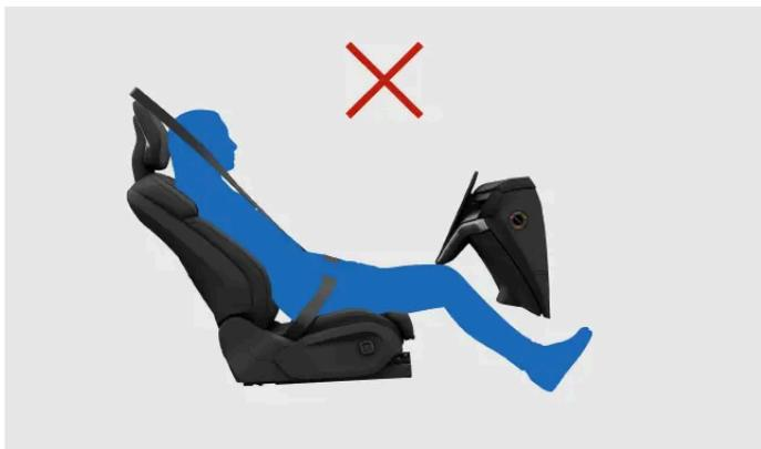
Neigen Sie die Rückenlehne nicht in eine liegende Position. Der Sicherheitsgurt muss gespannt über der Schulter liegen.
