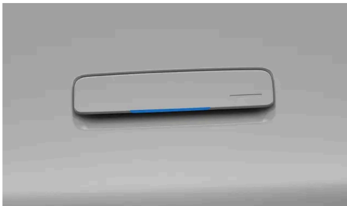
Berührungsempfindliche Fläche an der Unterseite des Türgriffs.
