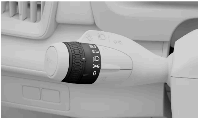
Symbol des Abblendlichts am Drehring des linken Lenkradhebels
