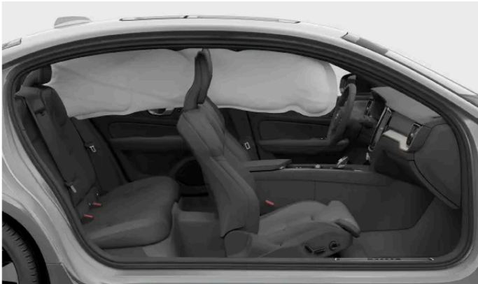
Auf einer Seite des Fahrzeugs ausgelöster Kopf-/Schulterairbag.
