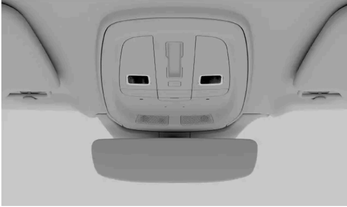
Die vorderen Leseleuchten an der Deckenkonsole
