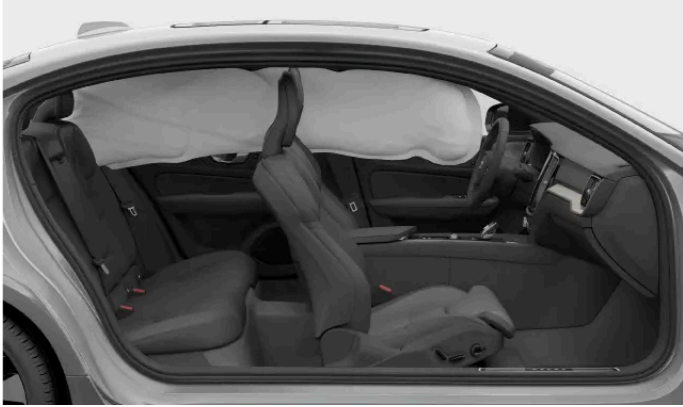
Auf einer Seite des Fahrzeugs ausgelöster Kopf-/Schulterairbag.
