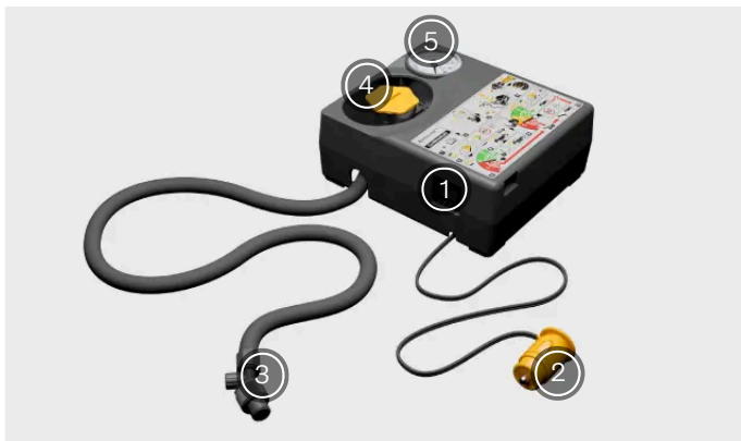
Übersicht über den Kompressor des Reifenpannen-Sets
