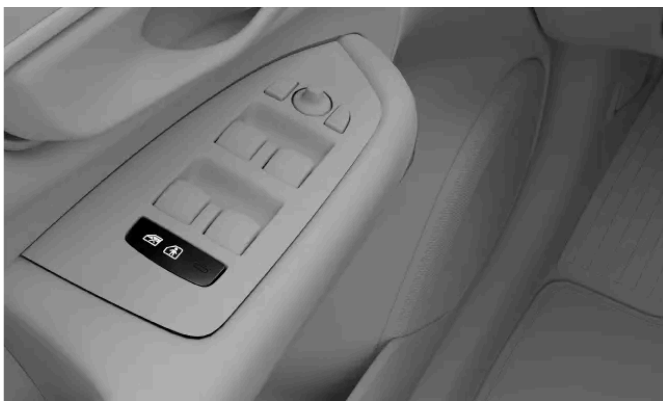
Position der Kindersicherungstaste in der Türverkleidung
