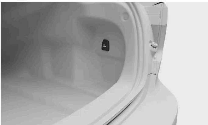
Die 12-V-Steckdose an der rechten Kofferraumwand
