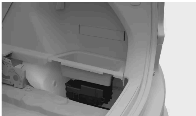
Lage des Sicherungskastens
