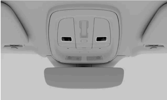
Die vorderen Leseleuchten an der Deckenkonsolle
