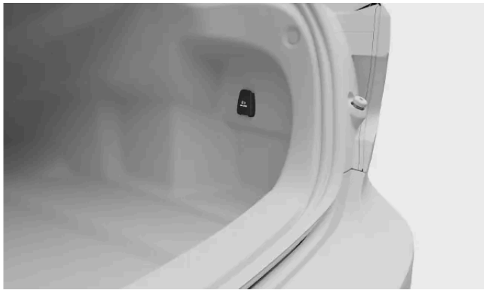
Die 12-V-Steckdose an der rechten Kofferraumwand
