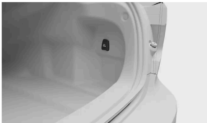
Die 12-V-Steckdose an der rechten Kofferraumwand
