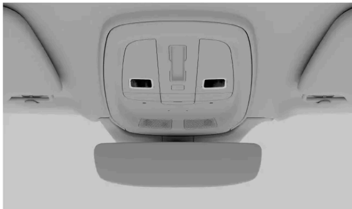
Die vorderen Leseleuchten an der Deckenkonsolle
