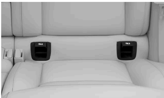
Lage der ISOFIX-Verankerungspunkte an den äußeren Rücksitzen
