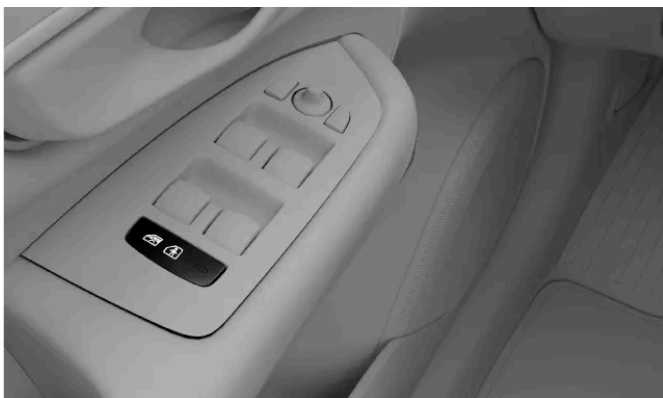
Position der Kindersicherungstaste in der Türverkleidung
