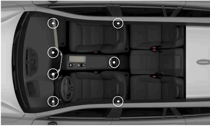
Lage der verstellbaren Lüftungsdüsen
