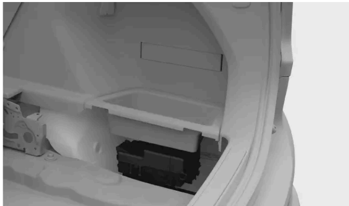
Lage des Sicherungskastens
