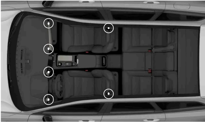
Lage der verstellbaren Lüftungsdüsen
