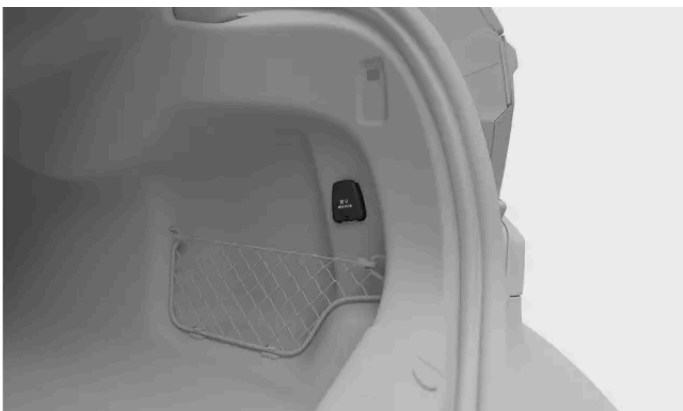
Die 12-V-Steckdose an der rechten Kofferraumwand
