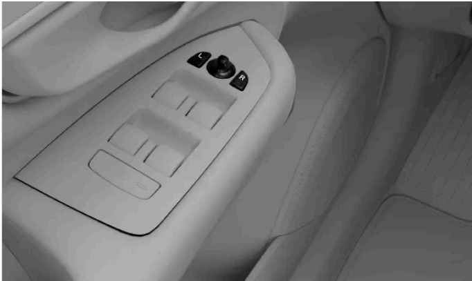
Bedienelemente zum Einstellen der Außenspiegel
