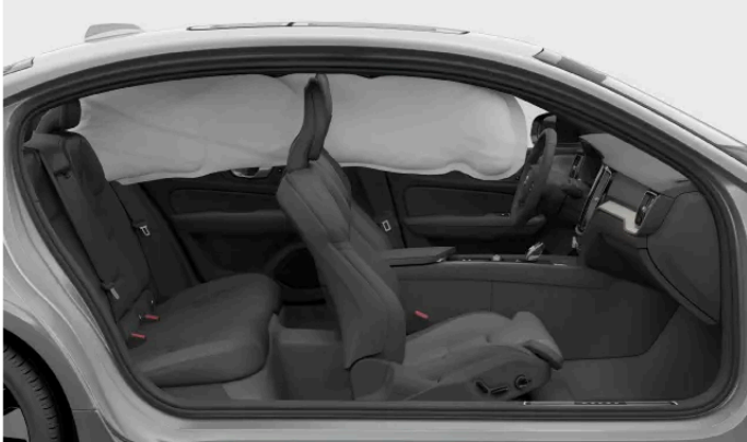
Auf einer Seite des Fahrzeugs ausgelöster Kopf-/Schulterairbag.
