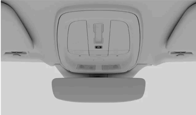
Die Taste zum Deaktivieren der automatischen Beleuchtung an der Deckenkonsolle
