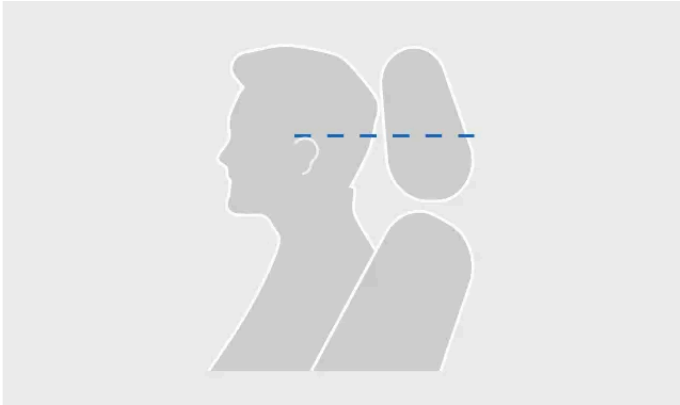
Die korrekte Höhe der Kopfstütze
