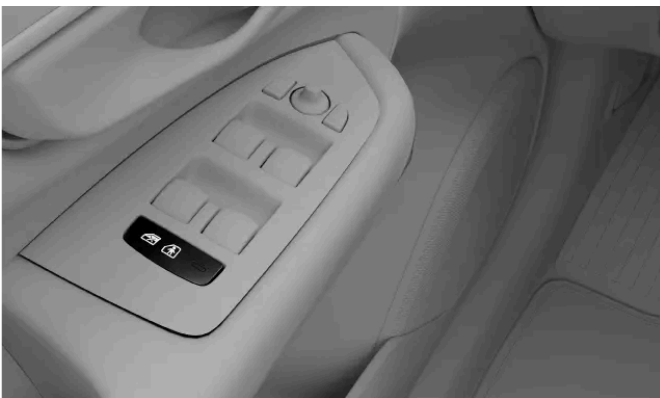
Position der Kindersicherungstaste in der Türverkleidung
