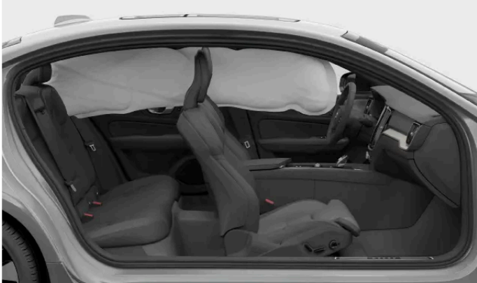
Auf einer Seite des Fahrzeugs ausgelöster Kopf-/Schulterairbag.
