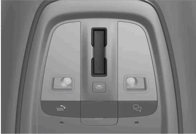
Das Schiebedach wird mit einem Regler an der Decke bedient. Der Regler kann bedient werden, wenn die Fahrzeugelektrik in Zündstellung I oder II steht.
