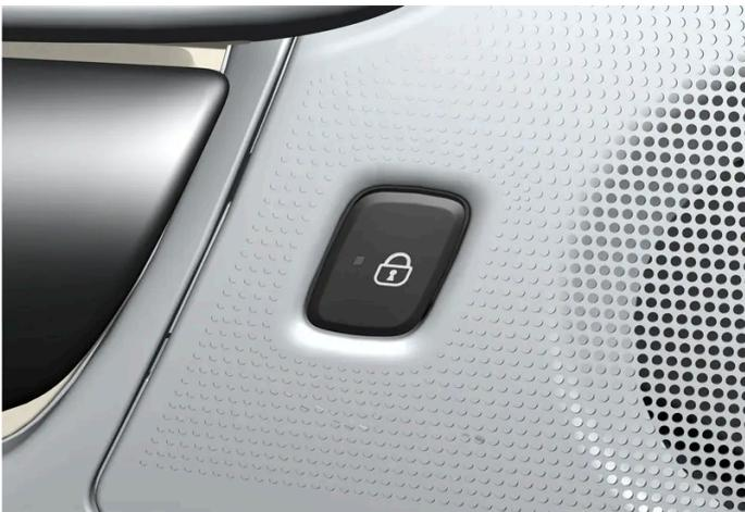
Verriegelungstaste mit Anzeileuchte an der Hintertür.
