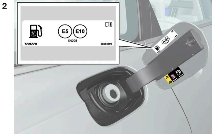
Kraftstoff tanken, der gemäß der Kennzeichnung<sup>[1]</sup> auf der Innenseite der Tankklappe für das Fahrzeug zugelassen ist. Zu zugelassenen Kraftstoffen und ihrer Kennzeichnung siehe die Abschnitte „Benzin“ bzw. „Diesel“.
