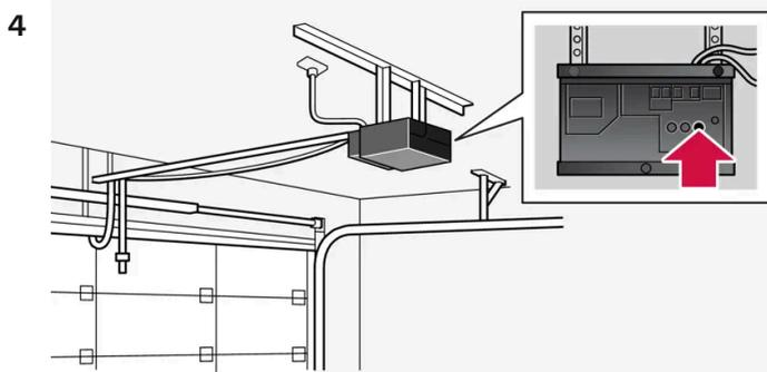
Finden Sie die Ankerntaste<sup>[2]</sup> am Empfänger, z. B. Garagentor. Die Platzierung ist normalerweise in der Nähe der Antennenfassung am Empfänger.
