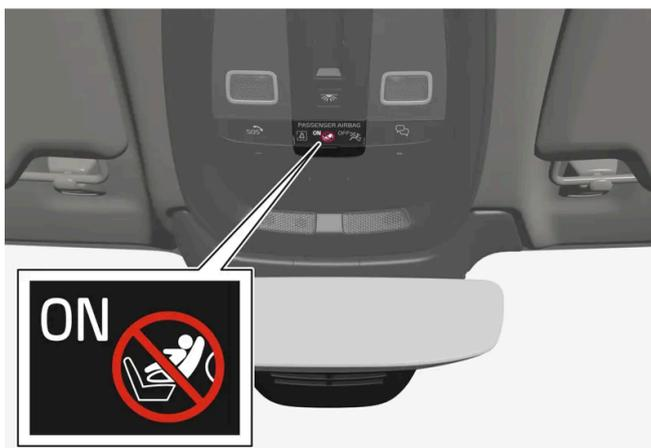
➤ Eine Textmeldung und ein Warnsymbol in der Deckenkonsolle zeigen an, dass der Beifahrerairbag aktiviert ist.
