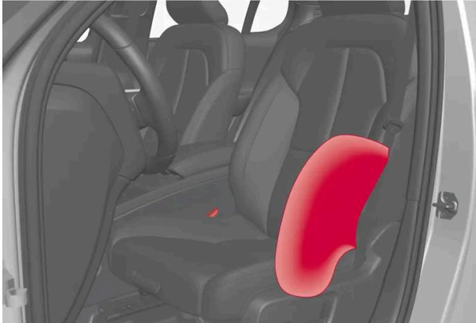
Die äußeren Seitenairbags sind im Außenrahmen der Rückenlehnen montiert und helfen, Fahrer und Beifahrer in den Vordersitzen zu schützen.
