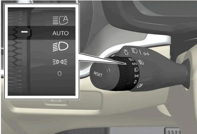
Drehring am Lenkradhebel in Stellung **AUTO**.
