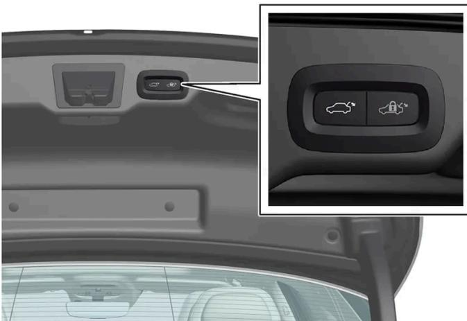
Lage der Taste an der Unterseite des Kofferraumdeckels.
