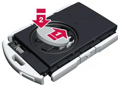
Setzen Sie eine neue Batterie mit dem (+)-Pol nach oben ein. Berühren Sie die Batteriekontakte des richtig Schlüssels nicht mit den Fingern.
