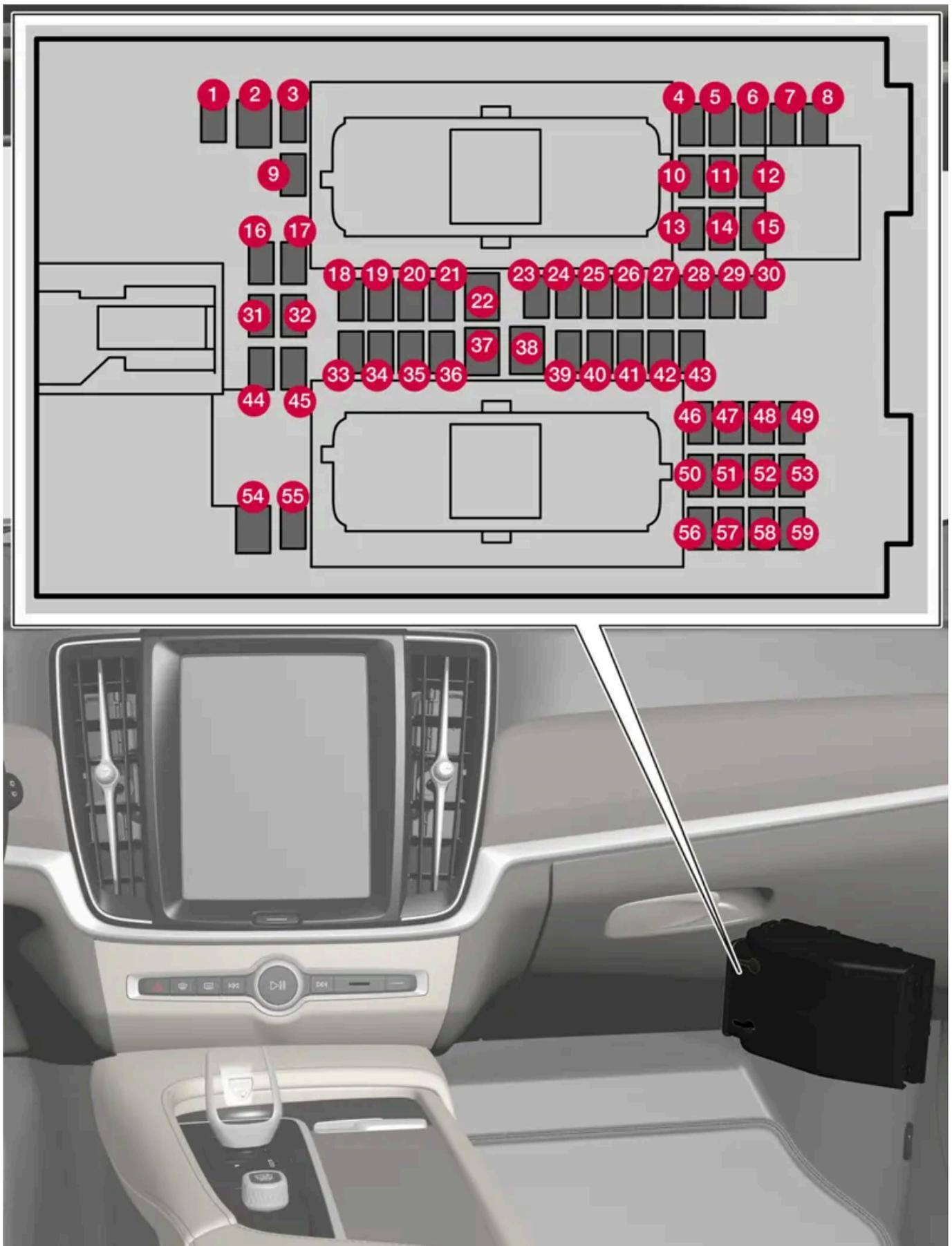
Der Sicherungskasten befindet sich hinter der Bodenmatte/Seitenverkleidung.
