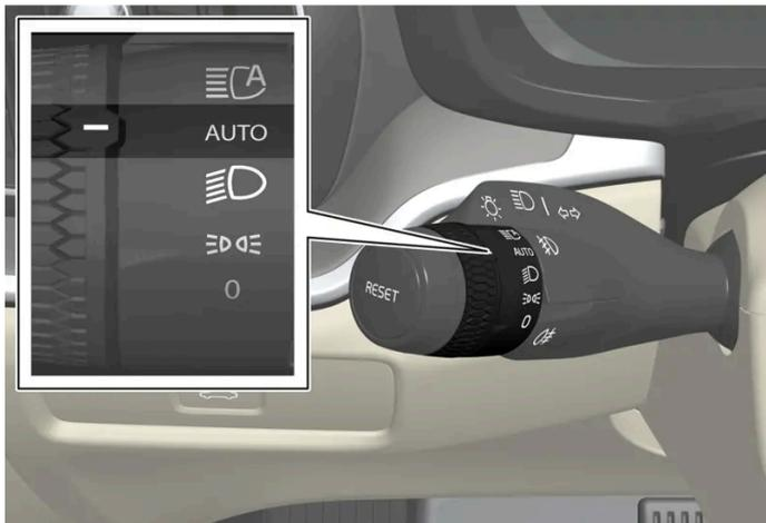
Drehring am Lenkradhebel in Stellung **AUTO**.
