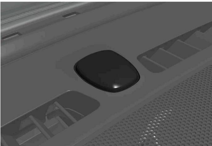
Die Verriegelungs- und Alarmanzeige befindet sich in der Mitte der Instrumententafel, nahe der Windschutzscheibe.
