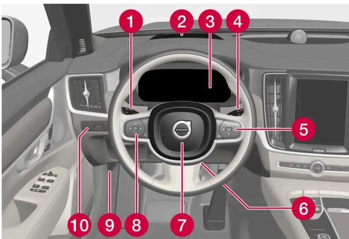
1 Positionsleuchten, Tagfahrlicht, Abblendlicht, Fernlicht, Blinker, Nebelscheinwerfer/Kurvenlicht\*, Nebelschlussleuchte, Zurücksetzen des Tageskilometerzählers
