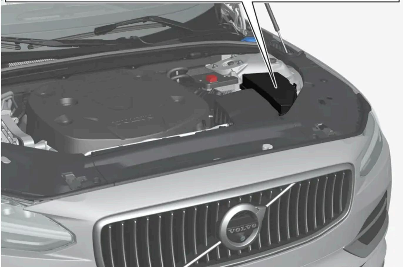
Innen an der Abdeckung befindet sich eine Spezialzange, die den Austausch ausgelöster Sicherungen vereinfacht.
