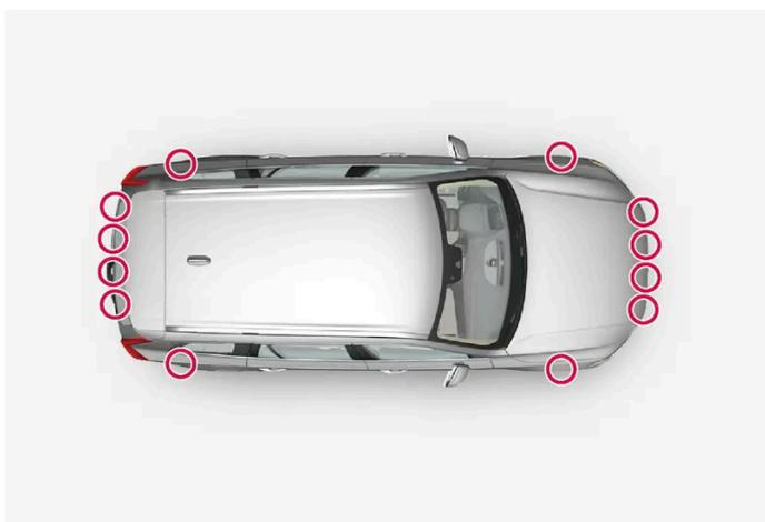
Lage der Einparkhilfesensoren rund um das Fahrzeug
