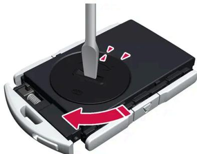
Legen Sie den Deckel des Batteriefachs wieder auf und drehen Sie ihn im Uhrzeigersinn in Stellung CLOSE.
