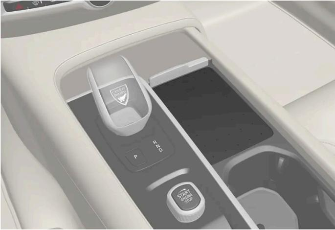
Kabellose Ladeablage an der Tunnelkonsole.
