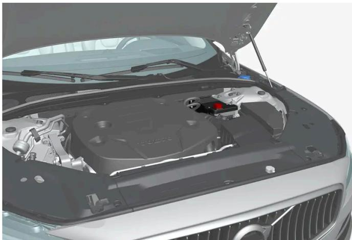
Die 12-V-Unterstützungsbatterie befindet sich im Motorraum.
