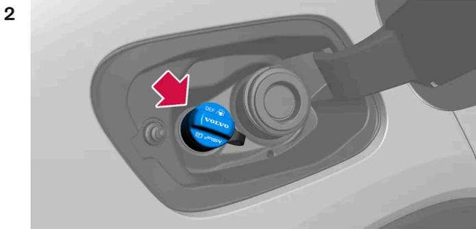
Öffnen Sie den blauen Verschluss zum kleineren Einfüllstutzen, der für AdBlue vorgesehen ist.
