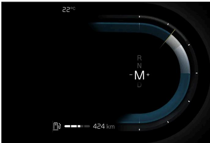
In Schaltstellung M ist ein manuelles Schalten möglich. Der Motor bremsst, wenn das Gaspedal losgelassen wird.
