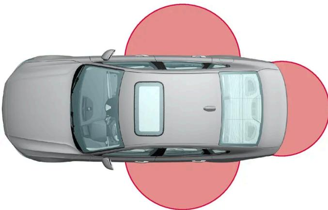
Für die schlüssellose Bedienung muss sich ein Schlüssel in einer Entfernung von ca. 1 bis 1,5 Meter (3 bis 5 Fuß) von den Fahrzeugtüren oder vom Kofferraumdeckel befinden.
