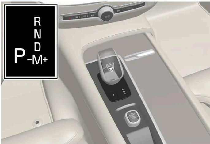
Wählhebel und Schaltmuster auf dem Fahrerdisplay.
