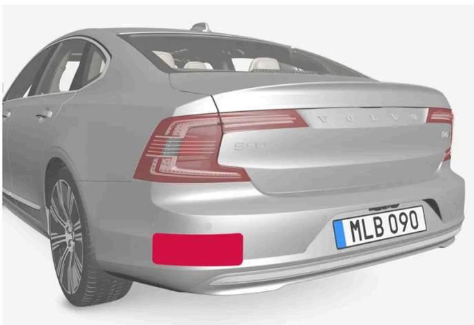
Platzierung der hinteren Radareinheiten
