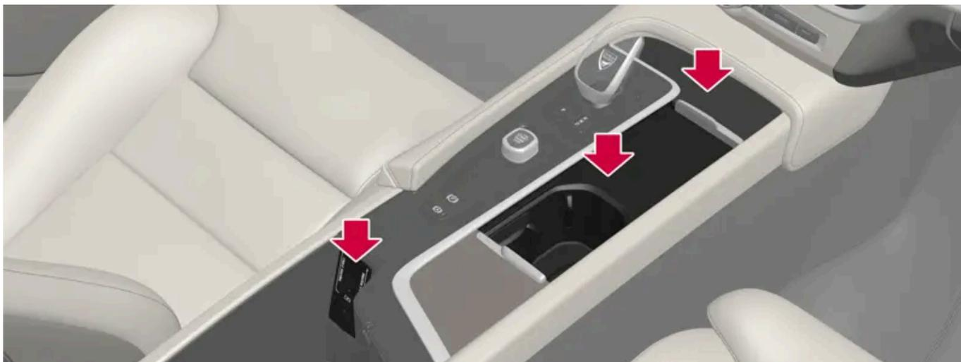
Ablagefächer mit Getränkehalter, induktives Smartphone-Ladesystem\*, Steckdose und USB-Buchsen an der Tunnelkonsole.
