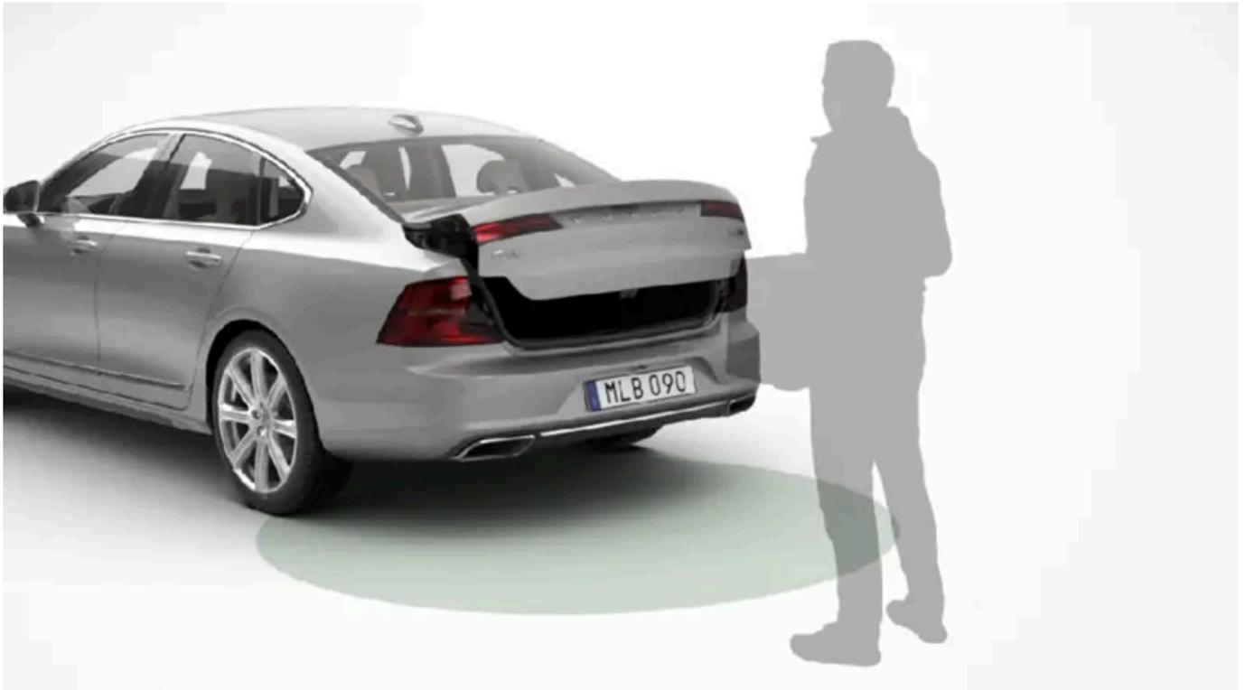
Wenn das Fahrzeug mit schlüsselloser Verriegelung und Entriegelung\* ausgerüstet ist, kann man den Kofferraumdeckel durch eine Fußbewegung öffnen. Zum Schließen muss das Fahrzeug außerdem mit einem elektrisch betätigten Kofferraumdeckel\* ausgestattet sein.
