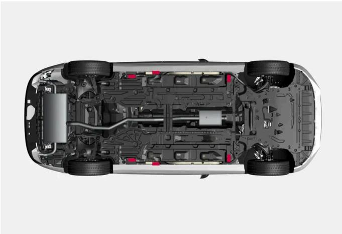
Das Fahrzeug verfügt über externe Ansatzpunkte für einfache Hebevorgänge und innere Ansatzpunkte für schwerere Hebevorgänge, z. B. mit Werkstatthebern oder Hebearmen.
