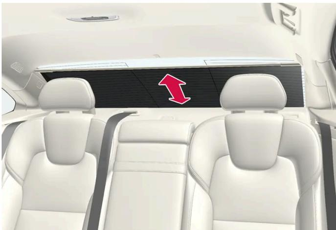
Eine elektrisch betätigte Sonnenblende ist in die Ablage der Heckscheibe eingebaut.
