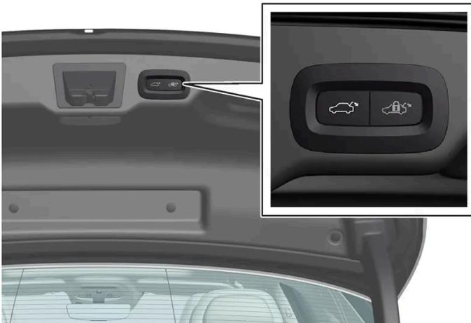
Lage der Taste an der Unterseite des Kofferraumdeckels.
