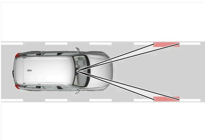
Driver Alert erfasst die Platzierung des Fahrzeug auf der Fahrbahn.
