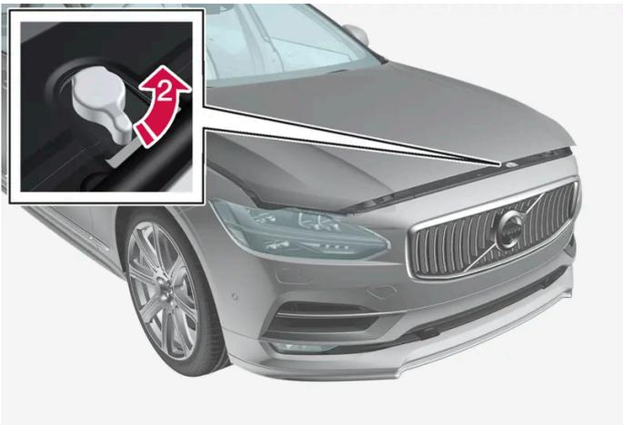
➔ Drehen Sie den Griff unter der Frontklappe zum Entriegeln gegen den Uhrzeigersinn und heben Sie die Klappe dann an.
