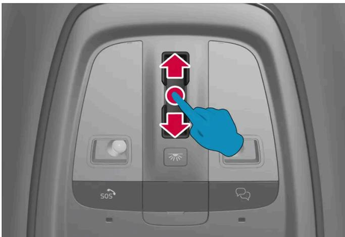
Schiebedach öffnen - über die Schalter nach hinten wischen. Das Schiebedach nimmt zunächst die Komfortstellung<sup>[1]</sup> ein. Zum vollständigen Öffnen – über die Schalter ein zweites Mal nach hinten wischen.
