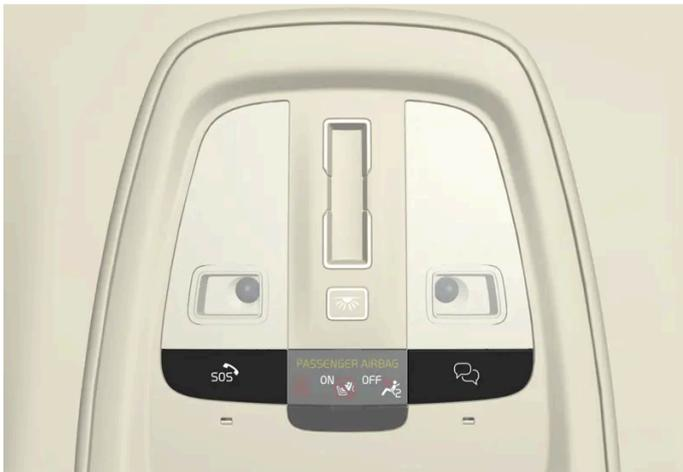
Die Funktionen sind über die
