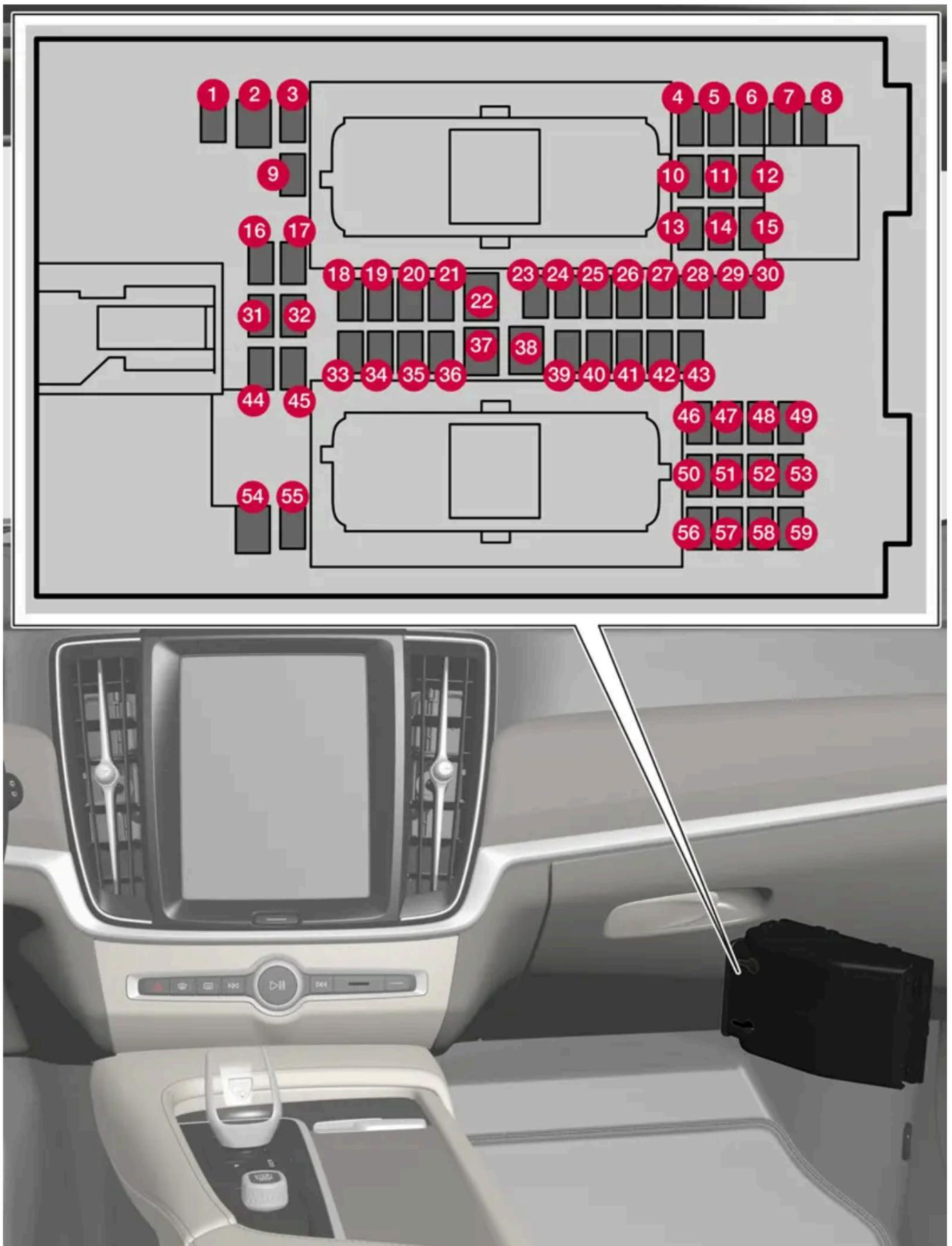
Der Sicherungskasten befindet sich hinter der Bodenmatte/Seitenverkleidung.
