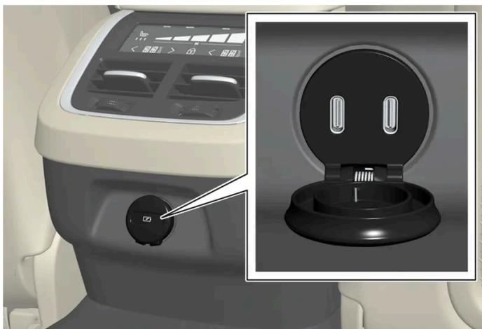
USB-Anschlüsse (Typ C) in der Tunnelkonsole, Fond.
