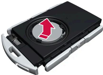
Die (+)-Seite der Batterie weist nach oben. Nehmen Sie die Batterie heraus, indem Sie sie an der Kante herunterdrücken und dann anheben.
