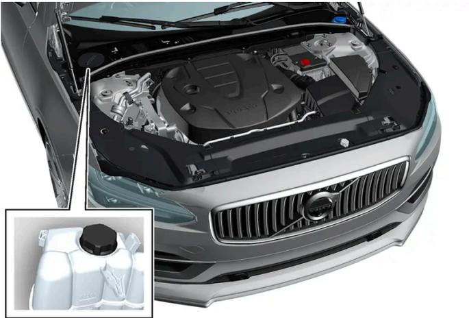
Ausgleichsbehälter der Kühlanlage, Linkslenker.
