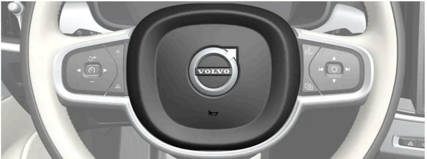
Das Signalhorn befindet sich in der Mitte des Lenkrads.
