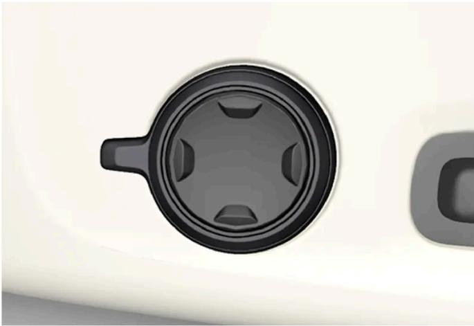
Multifunktionsschalter, in Fahrzeugen mit Vier-Wege-Lendenwirbelstütze\*.
