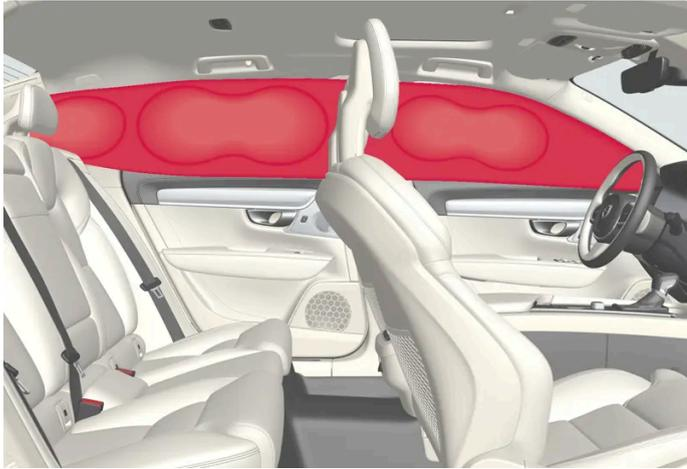
Diese sind rechts und links in den Dachhimmel eingelassen und schützen den Fahrer und die Insassen auf den äußeren Sitzplätzen. Die Verkleidung ist hier mit IC AIRBAG gekennzeichnet.
