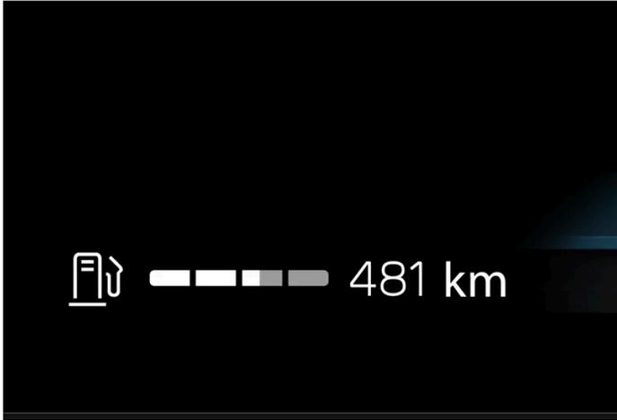
Der weiße Bereich der Tankanzeige entspricht der im Tank befindlichen Kraftstoffmenge.
