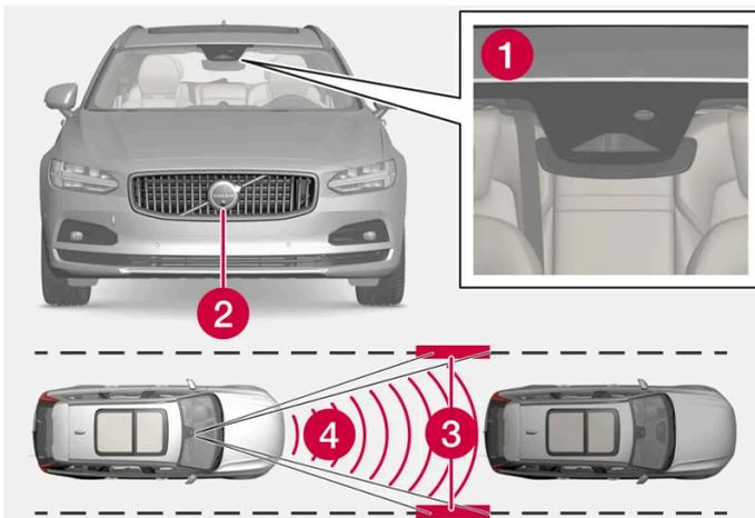
Die Kamera- und Radarmodule messen den Abstand zum vorausfahrenden Fahrzeug und erkennen seitliche Fahrbahnmarkierungen.
