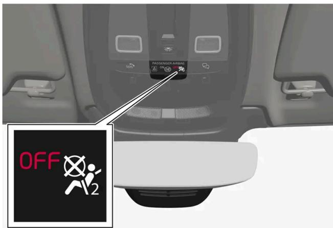
➤ Eine Textmeldung und ein Symbol in der Deckenkonsolle zeigen an, dass der Beifahrerairbag deaktiviert ist.
