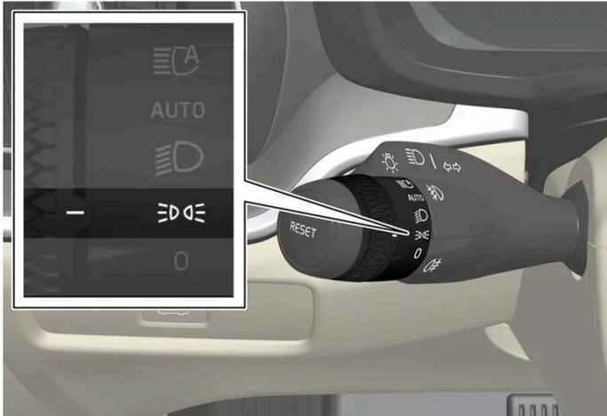
Drehring am Lenkradhebel in der Stellung für die Positionsleuchten.
