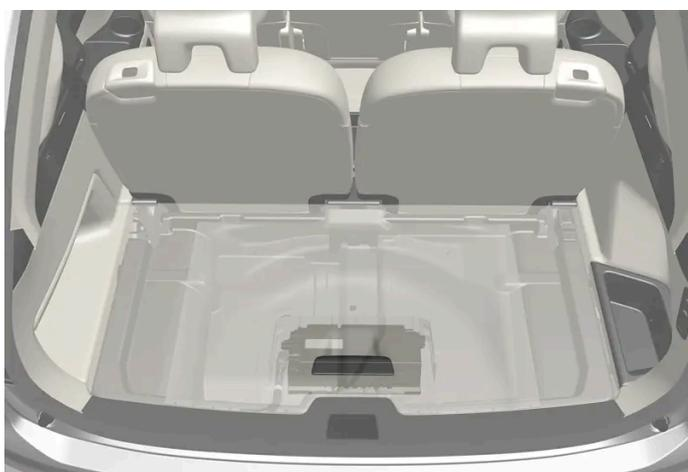
Mild-Hybrid-Fahrzeuge haben eine 48-V-Hilfsbatterie unter dem Laderaum. Arbeiten an Batterie und Batteriekasten dürfen nur von einer Vertragswerkstätte durchgeführt werden.
