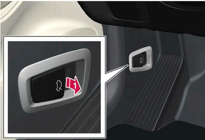
➔ Am Griff neben den Pedalen ziehen, um die Frontklappe aus der vollständig geschlossenen Stellung zu lösen.
