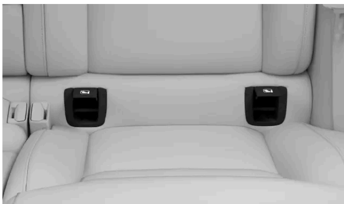
Lage der ISOFIX-Verankerungspunkte an den äußeren Rücksitzen
