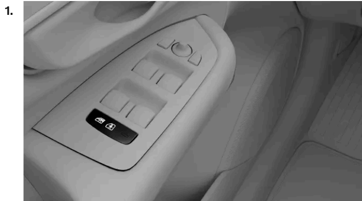
Position der Kindersicherungstaste in der Türverkleidung
