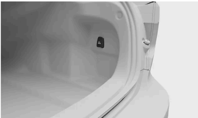
Die 12-V-Steckdose an der rechten Kofferraumwand
